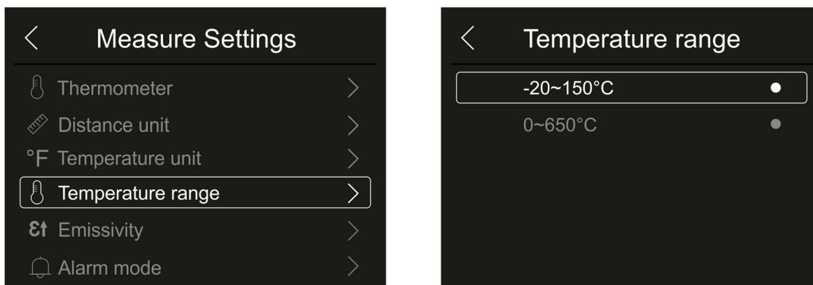
Fig. 26: Menu de configuração da variação de medição de temperatura
