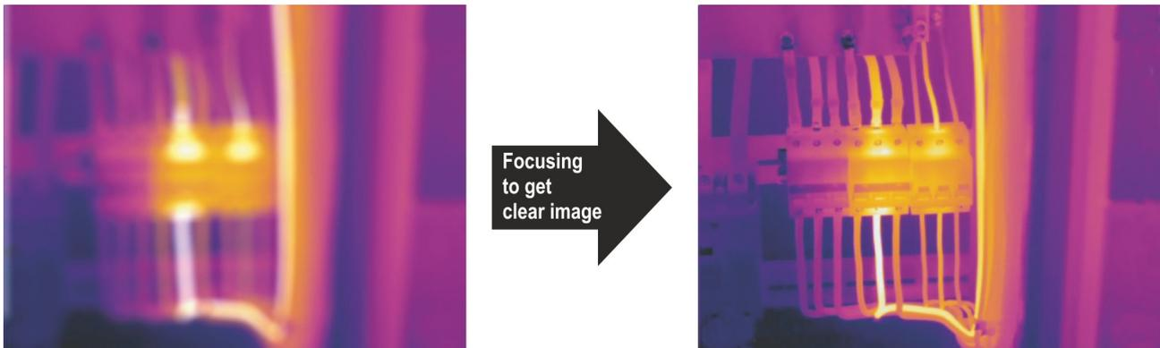
Fig. 7: Focar imagem do dispositivo
