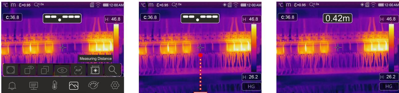
Fig. 37: Função de medição de distância com ponteiro laser
