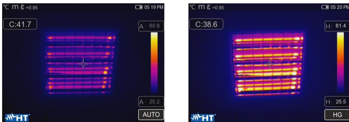
Fig. 46: Configuração do modo automático e histograma
