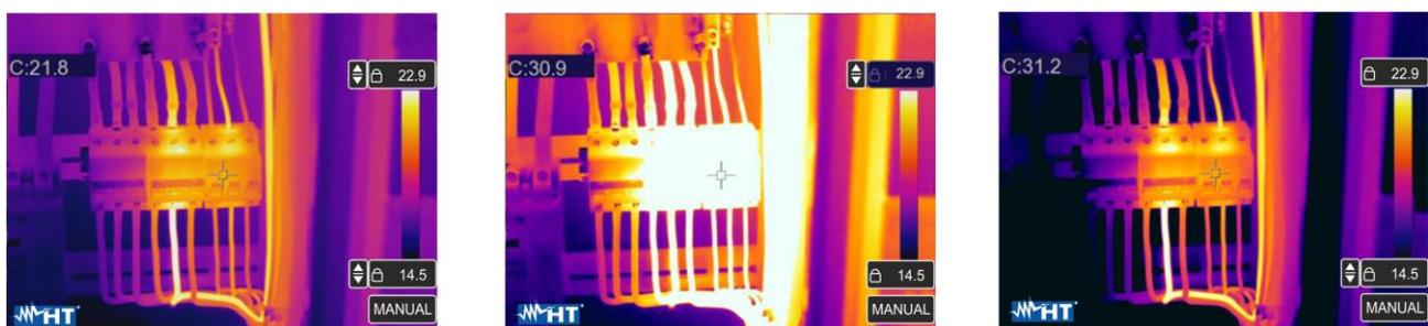
Fig. 47: Configuração do modo manual
