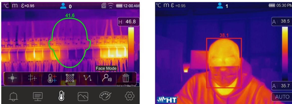
Fig. 54: Exibição de condição de alarme na função de triagem
