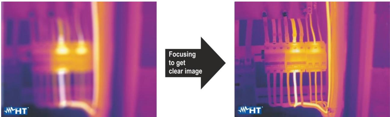
Fig. 8: Focar imagem do dispositivo
