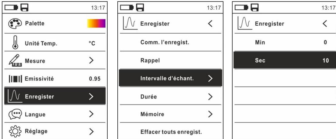
Fig. 31: Fonction data logger – Réglage de l'intervalle d'échantillonnage
