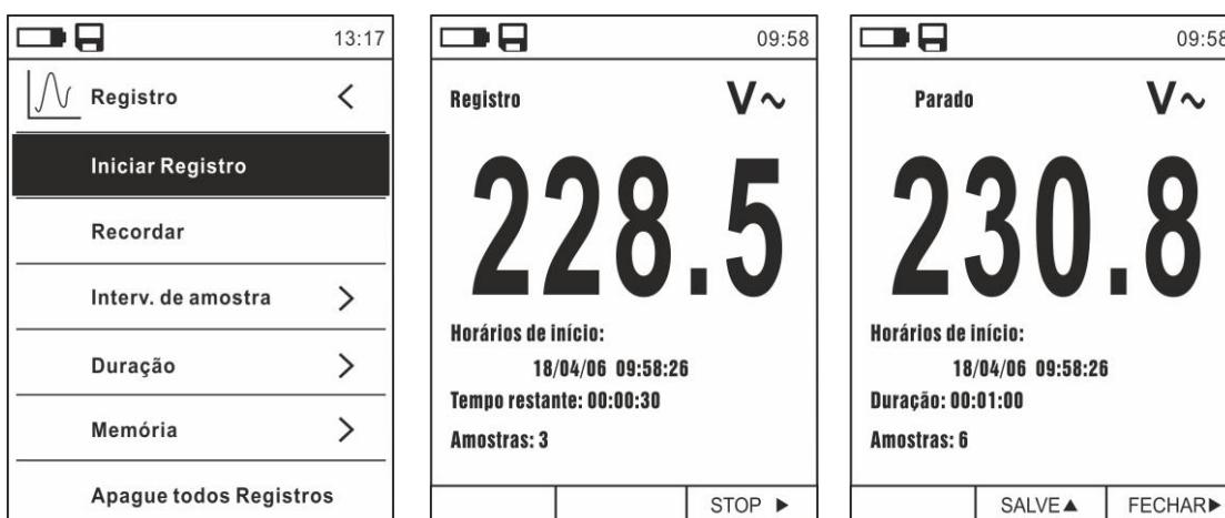
Fig. 33: Função data logger – Início e fim da gravação
