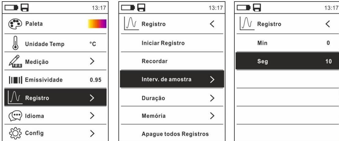
Fig. 31: Função data logger – Configuração do intervalo de amostragem
