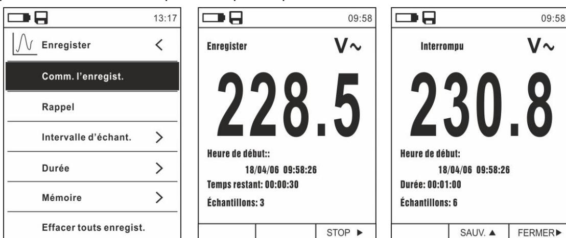
Fig. 33: Fonction data logger – Démarrage et arrêt de l'enregistrement
