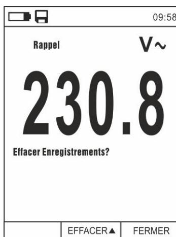
Fig. 36 : Fonction data logger – Suppression de l'enregistrement
