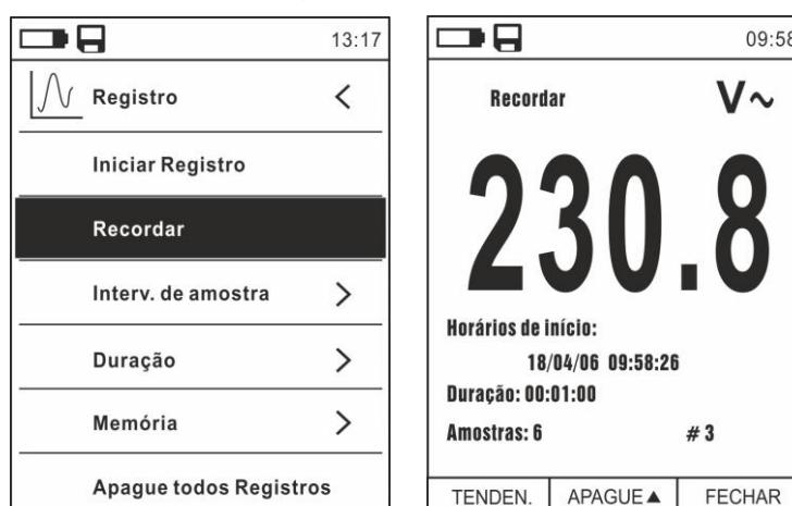
Fig. 34: Função data logger – Recordar no display os dados da gravação
