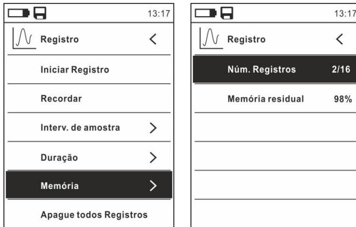
Fig. 37: Função data logger – Contenúdo da memória
