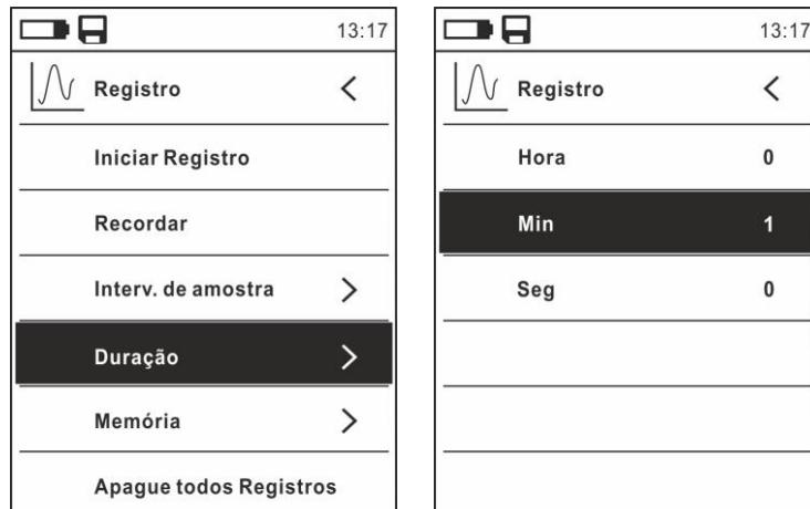
Fig. 32: Função data logger – Configuração da duração da gravação
