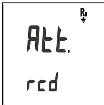
2. Se, durante a medição for detetada uma tensão de entrada **superior a 265V** (Exemplo: ambos os cabos ligados a condutores de fase de uma instalação trifásica 400V) o instrumento não efetua o teste. Será emitido um sinal acústico prolongado indicando a situação anómala e será apresentado o ecrã seguinte durante 5 segundos, decorrido o qual o instrumento apresenta o ecrã por defeito referente ao teste Ra  $\perp$
