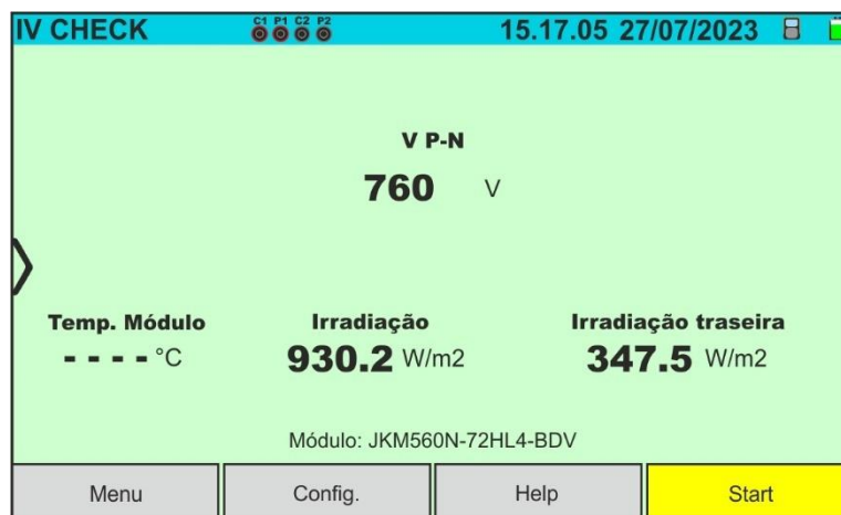
Fig. 65: Ecrã de medição da curva I-V inicial em módulos Bifaciais
