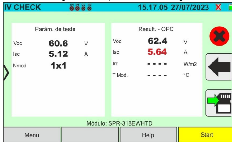
Fig. 62: Exemplo de um resultado negativo do teste IVCK - valores OPC
