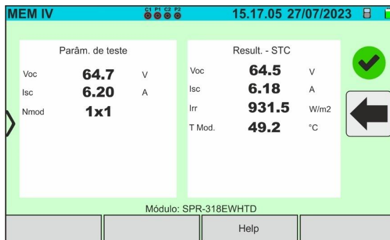
Fig. 94: Recuperação dos resultados do teste IVCK @STC
