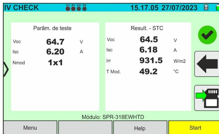
Fig. 67: Exemplo de um resultado positivo do teste IVCK - valores STC
