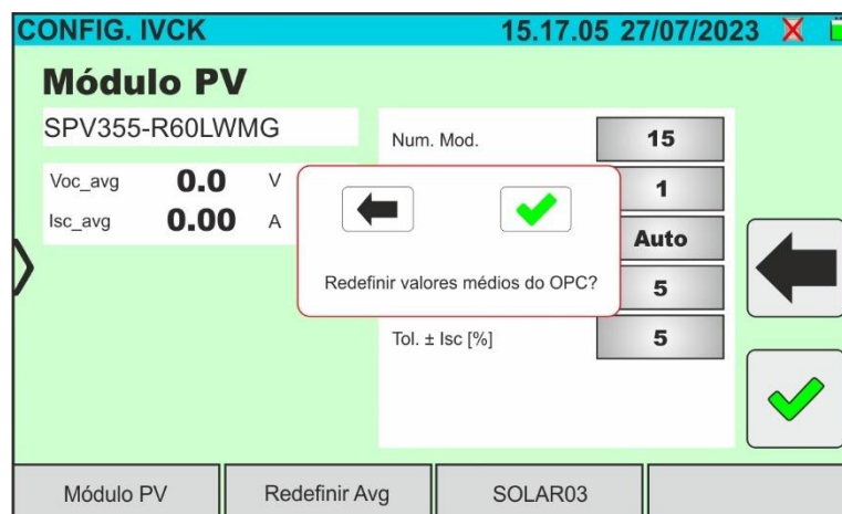
Fig. 60: Reposição dos valores médios de Voc e Isc no teste IVCK
