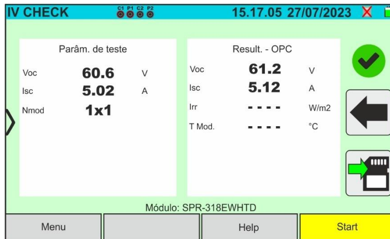
Fig. 61: Exemplo de um resultado positivo do teste IVCK - valores OPC
