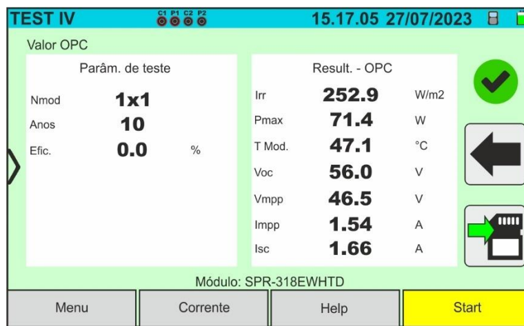
Fig. 44: Exemplo de resultado de medição da curva I-V - valores OPC
