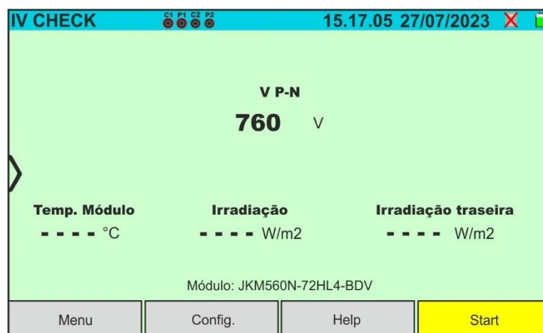
Fig. 36: Ecrã de teste inicial I-V sem unidade remota em módulos Bifaciais
