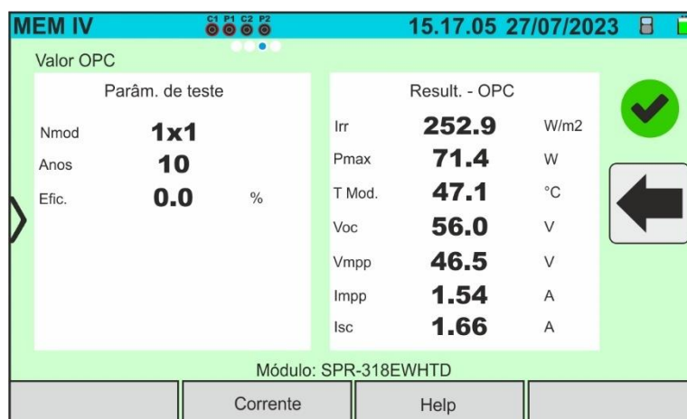
Fig. 91: Memorização dos resultados de medição da curva I-V - valores @OTC
