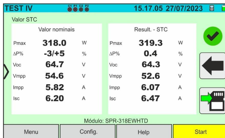
Fig. 43: Exemplo de resultado de medição da curva I-V - valores STC
