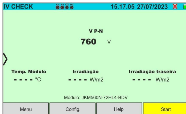
Fig. 58: Ecrã de teste inicial IVCK sem unidade remota em módulos Bifaciais
