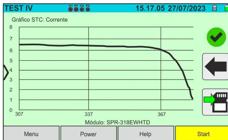
Fig. 45: Exemplo de resultado de medição da curva IV - curva STC
