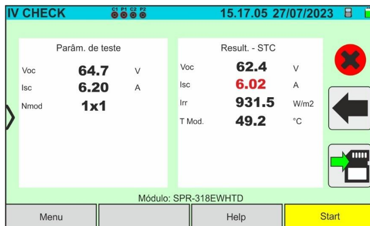
Fig. 68: Exemplo de um resultado negativo do teste IVCK - valores STC
