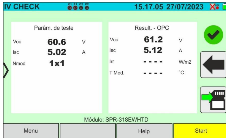
Fig. 76: Resultado da medição da curva I-V @OPC com registo síncrona
