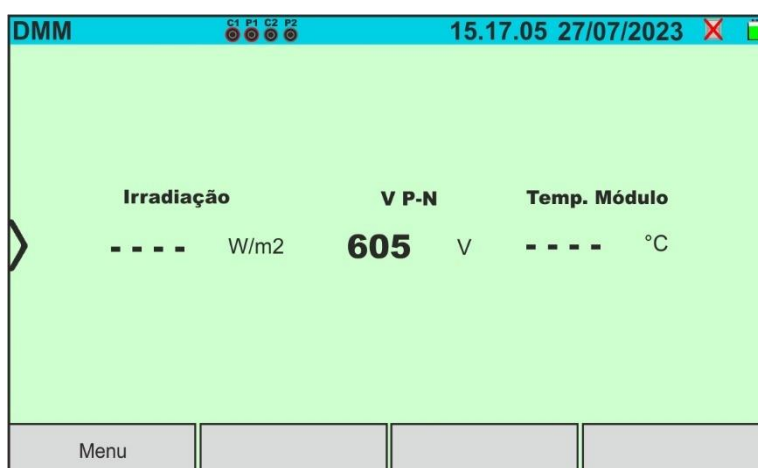
Fig. 14: Ecrã de medição da função DMM (SOLAR03 desligado)
