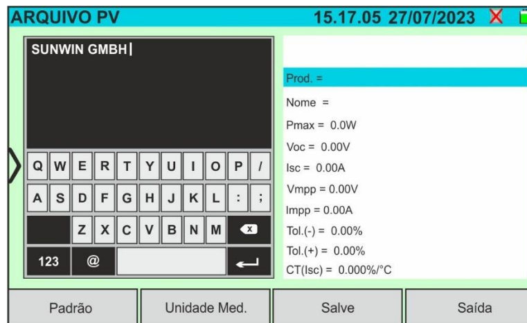
Fig. 25: Criar um novo módulo fotovoltaico - Passo 1
