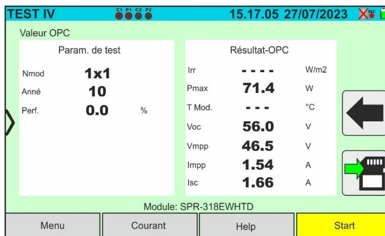
Fig. 54: Resultado da medição da curva I-V @OPC com registo síncrona
