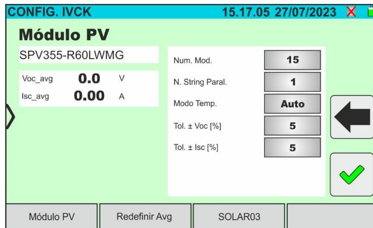
Fig. 59: Definições dos parâmetros de ensaio IVCK
