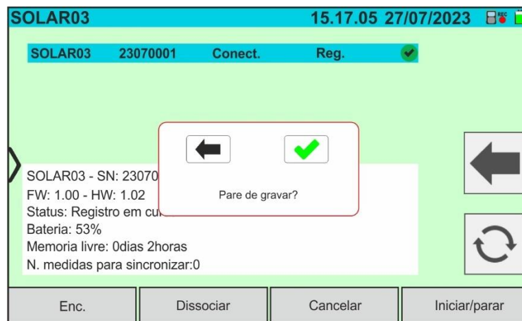
Fig. 55: Terminação do registo síncrona em curso na unidade remota
