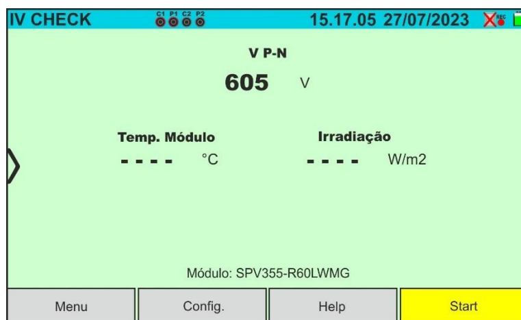
Fig. 73: Ecrã da test IVCK com SOLAR03 em registo síncrona em módulos Monofaciais
