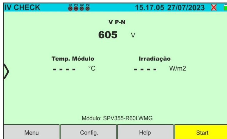
Fig. 57: Primeiro ecrã de teste IVCK sem unidade remota em módulos Monofaciais
