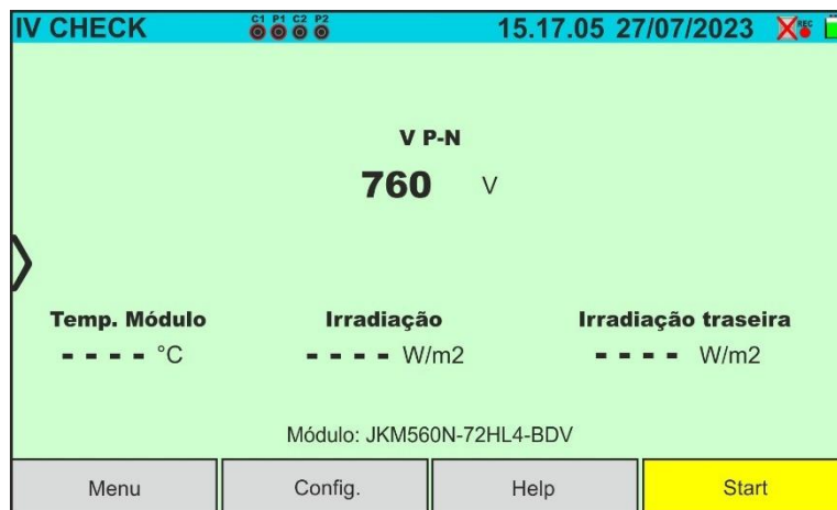
Fig. 74: Ecrã da test IVCK com SOLAR03 em registo síncrona em módulos Bifaciais
