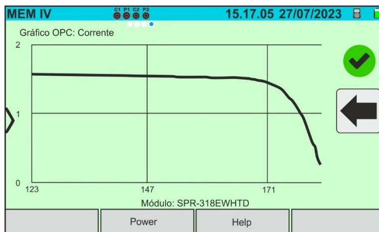
Fig. 92: Memorização dos resultados de medição da curva I-V - Curva de corrente @OPC
