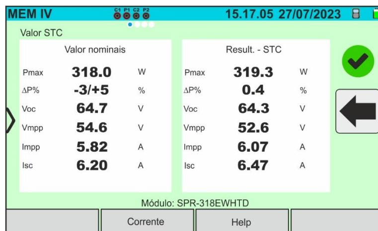
Fig. 88: Recuperação dos resultados de medição da curva IV - valores @STC
