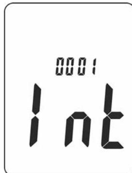
Fig. 7: Configuração do intervalo de amostragem
