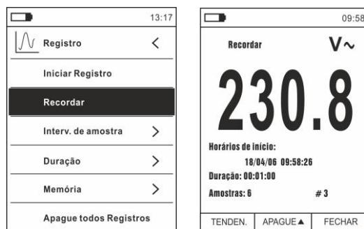
**Fig. 38:** Data logger – Recordar no display os dados da gravação
