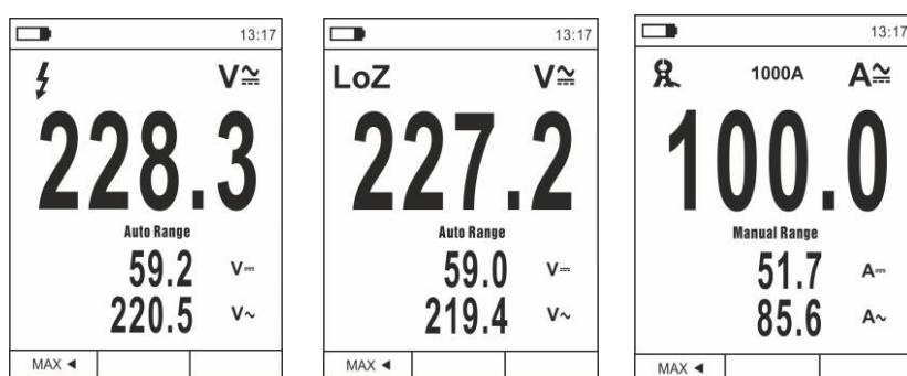
**Fig. 6** Description mesure tension et courant CA+CC
