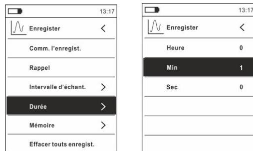
**Fig.36:** Data logger – Réglage de la durée d'enregistrement
