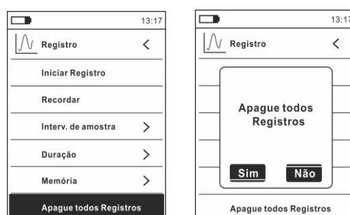
**Fig. 42:** Data logger – Eliminação de todas as gravações
