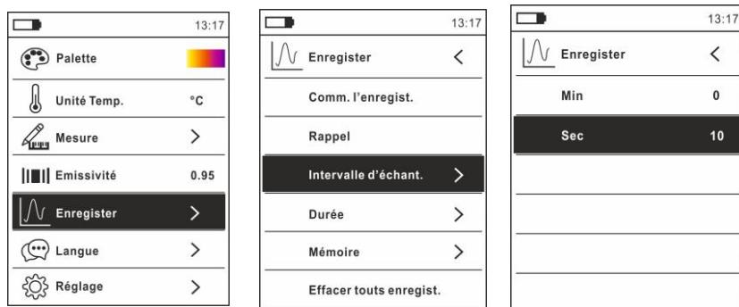
**Fig. 35** Data logger – Réglage de l'intervalle d'échantillonnage
