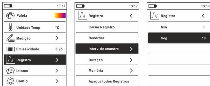
**Fig.35** Data logger – Configuração do intervalo de amostragem
