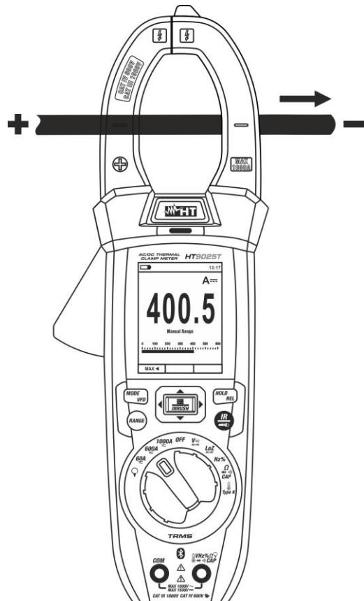
**Fig. 31** Mesure de la Courant CC
