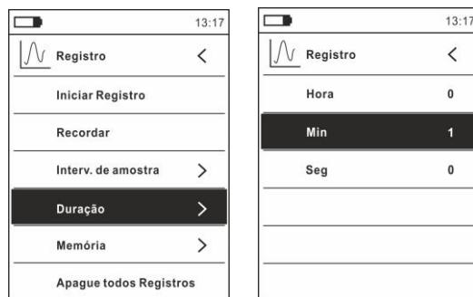
**Fig. 36:** Data logger – Configuração da duração da gravação
