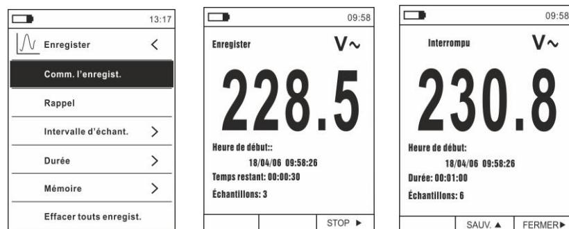
**Fig.37:** Data logger – Démarrage et arrêt de l'enregistrement
