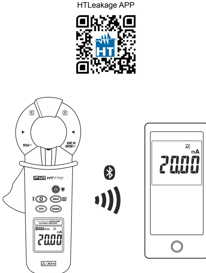
Fig. 8: Conexão do instrumento ao dispositivo móvel
