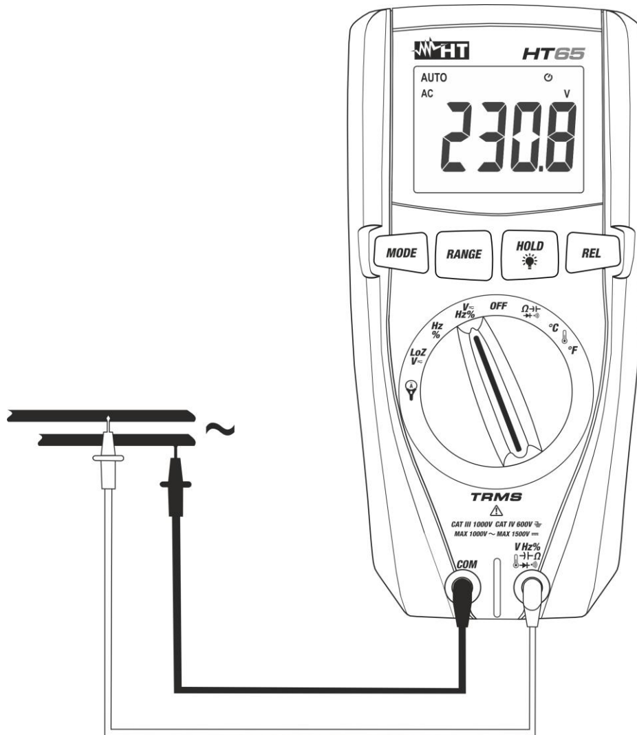
Abb. 3: Verwendung des Gerätes für AC Spannungsmessung
