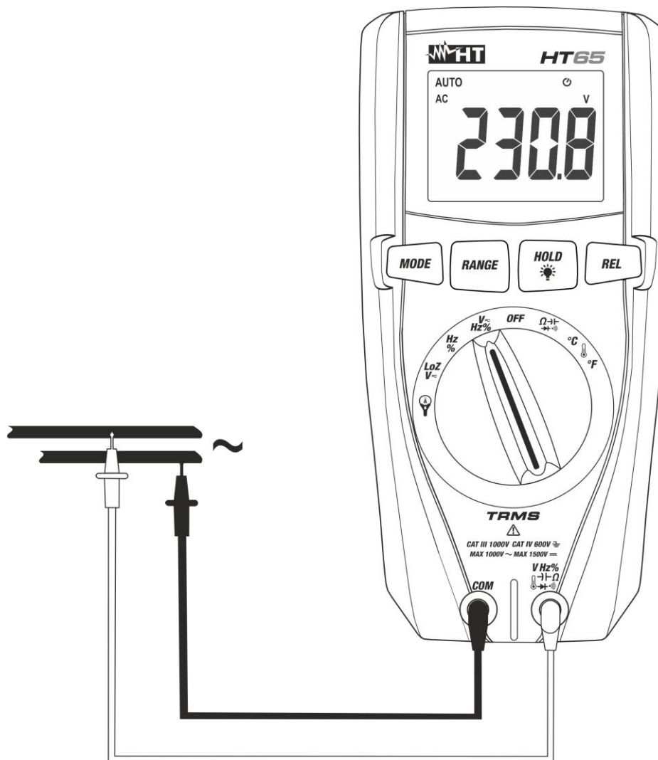
Fig. 3: Uso do instrumento para a medição de Tensões CA
