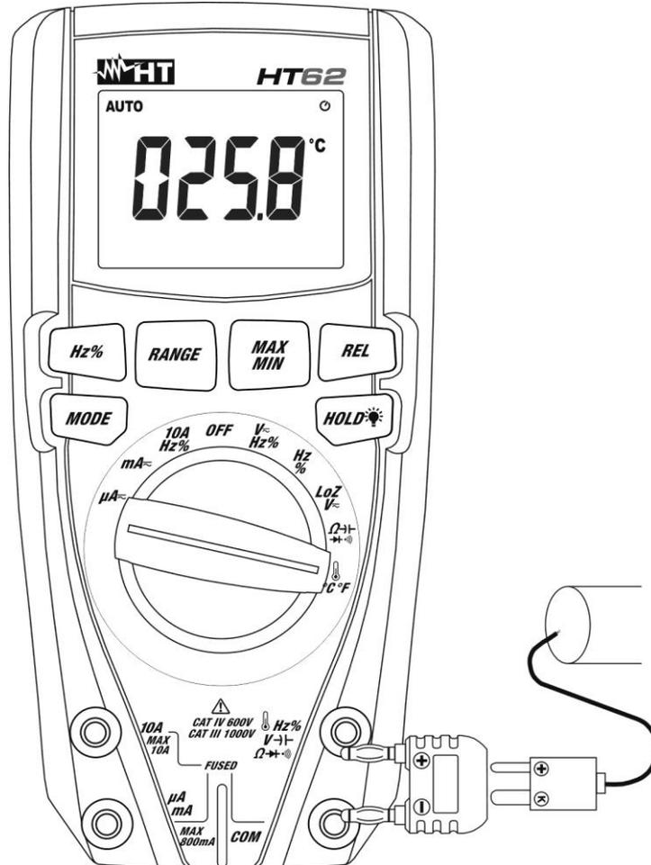
Abb. 9: Verwendung des Gerätes für Temperaturmessung
