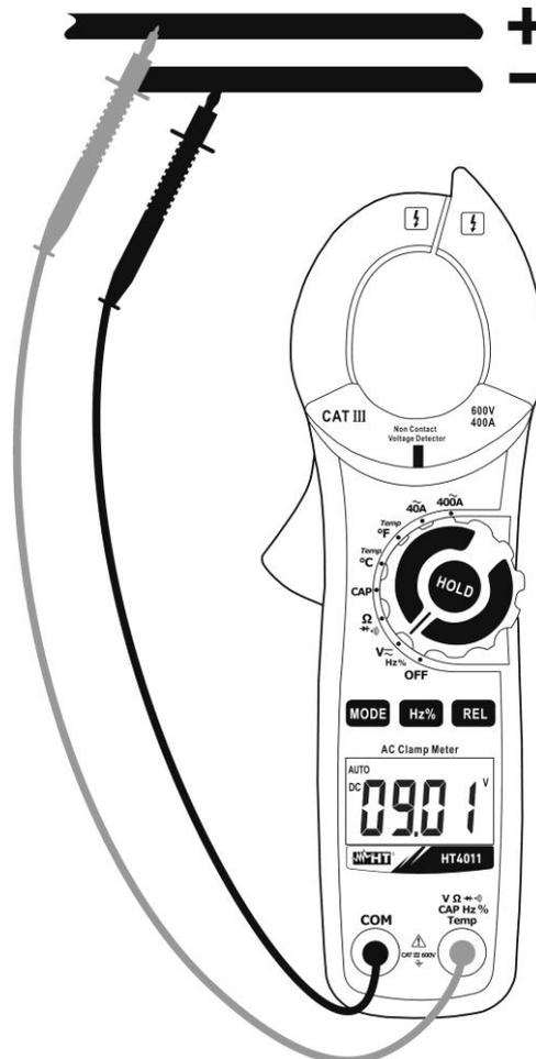
Fig. 2: Uso da pinça na medição de Tensões CC
