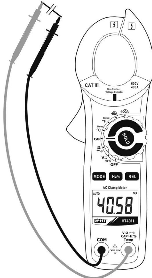
Fig. 6: Uso da pinça para medição de Capacidade
