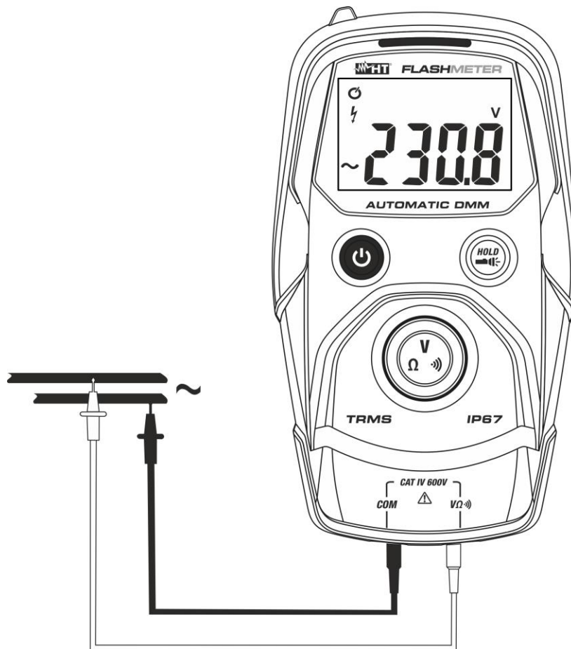
Abb. 4: Verwendung des Gerätes für Wechselspannungsmessung
