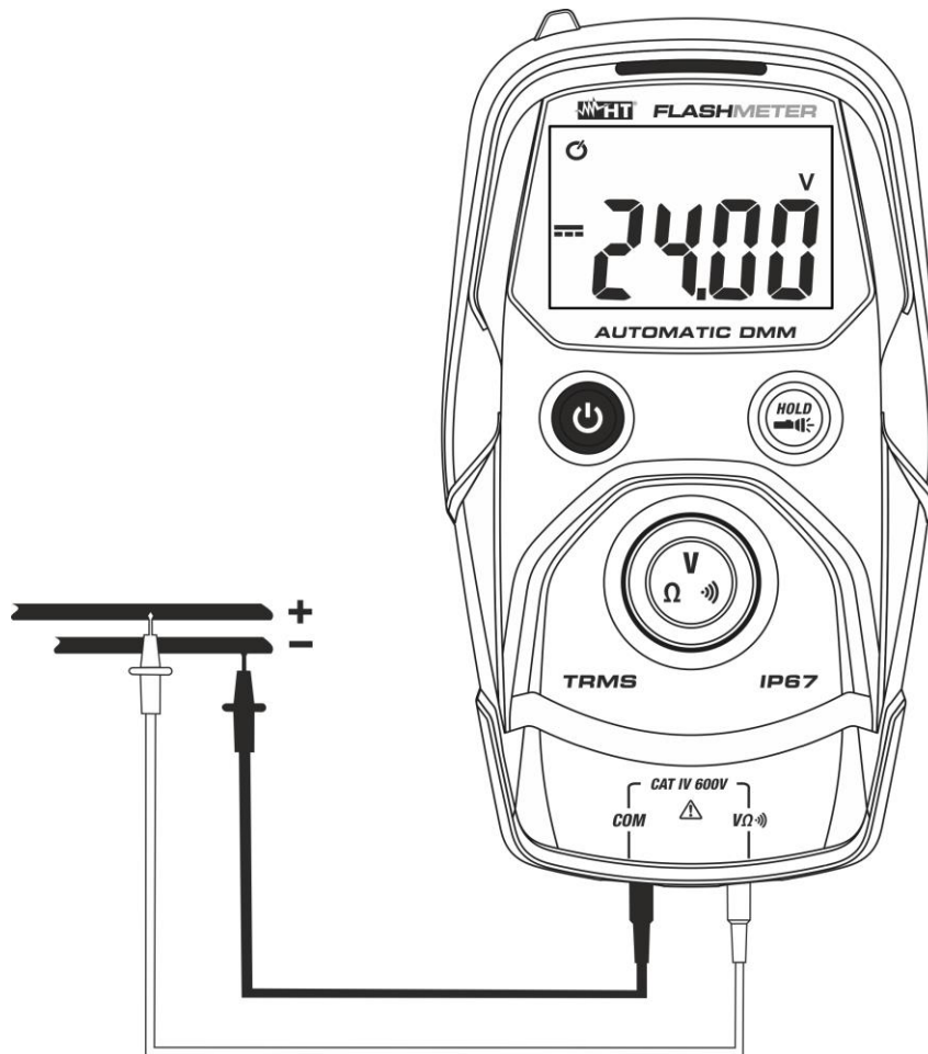
Abb. 3: Verwendung des Gerätes für Gleichspannungsmessung
