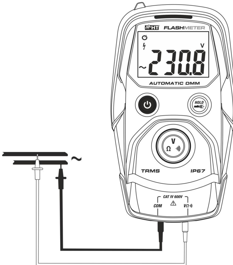
Fig. 4: Uso del instrumento para medida de Tensión CA
