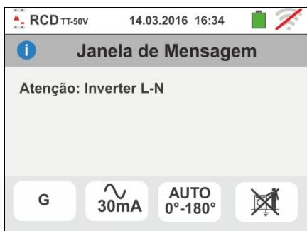
7. Quando é detectada a troca entre os terminais de fase e PE, o instrumento não efectua o teste e apresenta um ecrã como o mostrado ao lado. Verificar a ligação dos cabos de medida.
