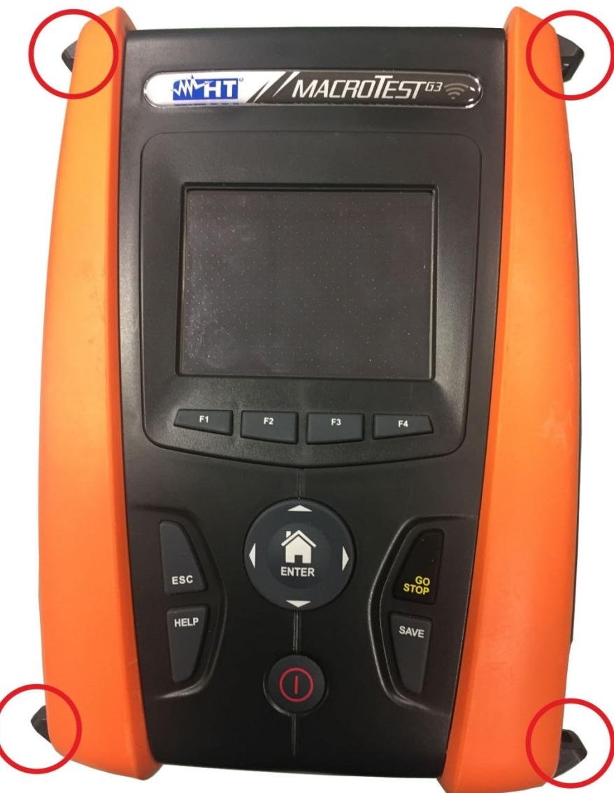
Fig. 42: Instrumento com peças hemisféricas e ganchos montados
