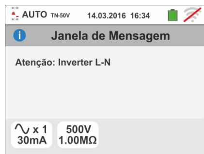
7. Quando é detetada uma troca entre os terminais de fase e PE, o instrumento não efetua o teste e apresenta um ecrã como o mostrado ao lado. Verificar a ligação dos cabos de medida
