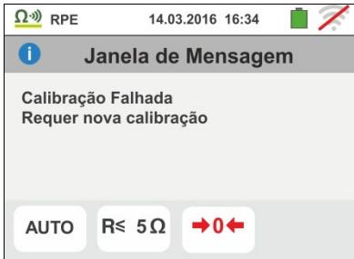
3. Quando ser executado o reset do calibração do cabos (executando a operação com terminais abertos) o instrumento emite um sinal acústico prolongado e apresenta um ecrã como o mostrado ao lado. O ícone é apresentado no display para indicar que o valor da calibração foi colocado em zero
