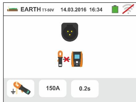
2. Ligar a pinça T2100 inserindo o conector na entrada In1 do instrumento. Ligar a pinça e colocá-la no modo “RS232” (ver manual de instruções da pinça). O símbolo aparece no display da pinça. **Nestas condições o conjunto instrumento-pinça já está pronto para efectuar as medições.** No display é apresentado o seguinte ecrã do instrumento:
