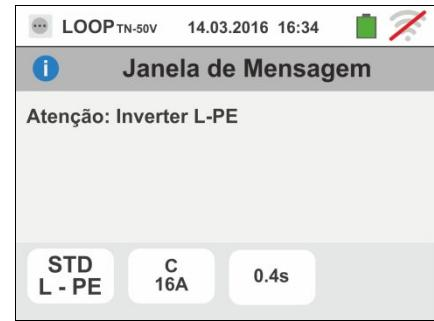
8. Quando é detectada a presença de uma tensão perigosa no terminal PE o instrumento não efectua o teste e apresenta um ecrã como o mostrado ao lado.
