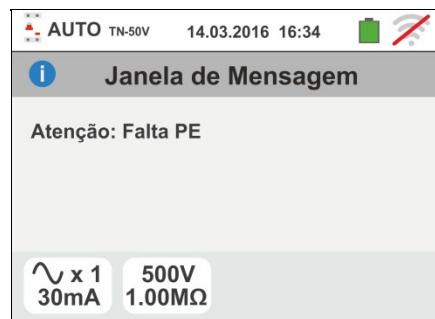
6. Quando é detetada uma troca entre os terminais de fase e neutro, o instrumento não efetua o teste e apresenta um ecrã como o mostrado ao lado. Rodar a ficha shuko ou verificar a ligação dos cabos de medida
