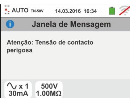
11 Se o instrumento detecta nos seus terminais uma tensão superior a 10V não executa o teste de isolamento L/N-PE, emite um sinal acústico prolongado e apresenta um ecrã como o mostrado ao lado
