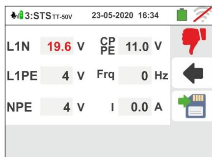
Pressione o botão **SAVE** ou toque no ícone para guardar parcialmente o teste e terminar a sequência de teste. O instrumento mostra a mensagem mostrada na imagem a seguir por alguns segundos
