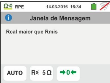
5. Se o instrumento detecta nos seus terminais uma tensão superior a 10V não executa o teste, emite um sinal acústico prolongado e apresenta um ecrã como o mostrado ao lado
