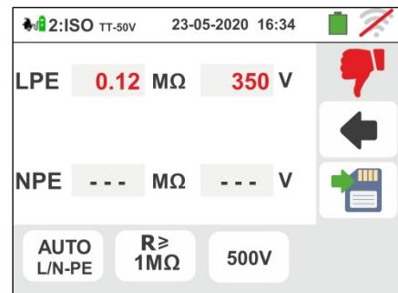
Pressione o botão **SAVE** ou o ícone para guardar parcialmente o teste e terminar a sequência de teste. O instrumento mostra a mensagem na imagem a seguir por alguns segundos
