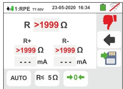
Pressione o botão **SAVE** ou o ícone para guardar parcialmente o teste e terminar a sequência do teste. O instrumento mostra a mensagem no ecrã a seguir por alguns segundos
