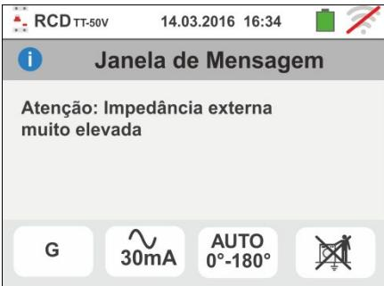
13 **Apenas para testes em RCD do tipo B/B+** nos casos em que o instrumento não é capaz de proporcionar a carga dos condensadores internos do diferencial apresenta a mensagem mostrada ao lado. Verificar se a tensão VL-N é superior a 190V.
