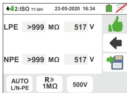
13 **Para sistemas EVSE trifásicos**, o resultado da medição do primeiro teste L1PE é mostrado na imagem ao lado. Os valores das tensões reais de teste
