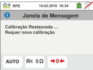
4. Quando é detectado que a resistência calibrada é mais elevada que a resistência medida (poe exemplo para uso do cabos diferentes dos fornecidos), o instrumento emite um sinal acústico prolongado e apresenta um ecrã como o mostrado ao lado. Execute um reset e faça uma nova calibração
