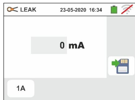
2. Tocar o ícone para colocar em zero o valor no campo IN e usar o teclado virtual para configurar o valor do fundo da escala da pinça utilizada (valores 1A, 100A 1000A para pinça HT96U)
