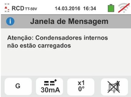
14 **Apenas para testes em RCD do tipo B/B+** nos casos em que o instrumento detecta uma tensão de entrada Fase-Neutro <190V, o teste é bloqueado e é apresenta a mensagem mostrada ao lado. Verificar os valores das tensões na instalação.
