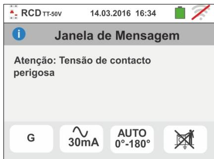
11 Se o instrumento detecta uma tensão Vn-pe >50V (ou uma análoga Vn-pe > 25V) bloqueia o teste por motivos de segurança e apresenta a mensagem mostrada ao lado. Verificar a eficiência do condutor PE e da instalação de terra.
