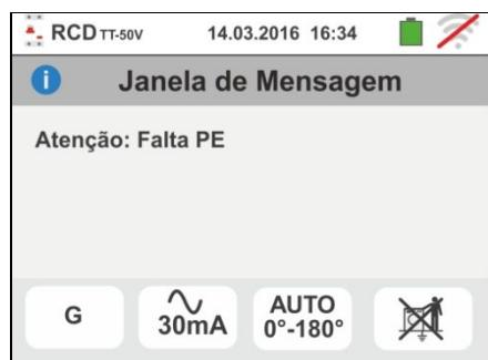
6. Quando é detectada a troca entre os terminais de fase e neutro, o instrumento não efectua o teste e apresenta um ecrã como o mostrado ao lado. Rodar a ficha shuko ou verificar a ligação dos cabos de medida.
