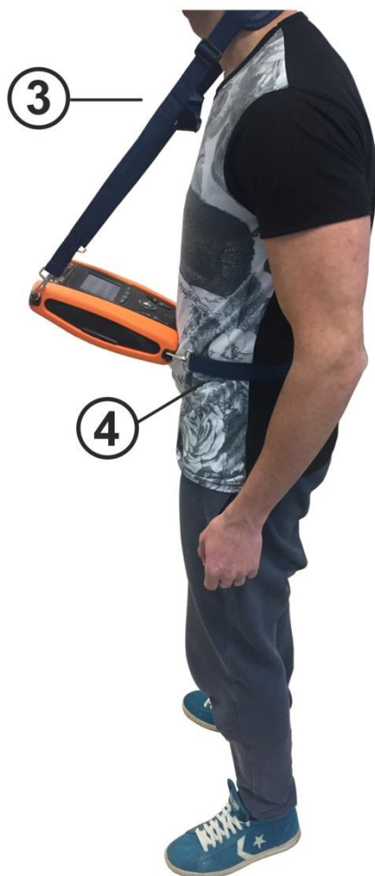
Fig. 43: Montagem completa do conjunto de correias SP-0500
