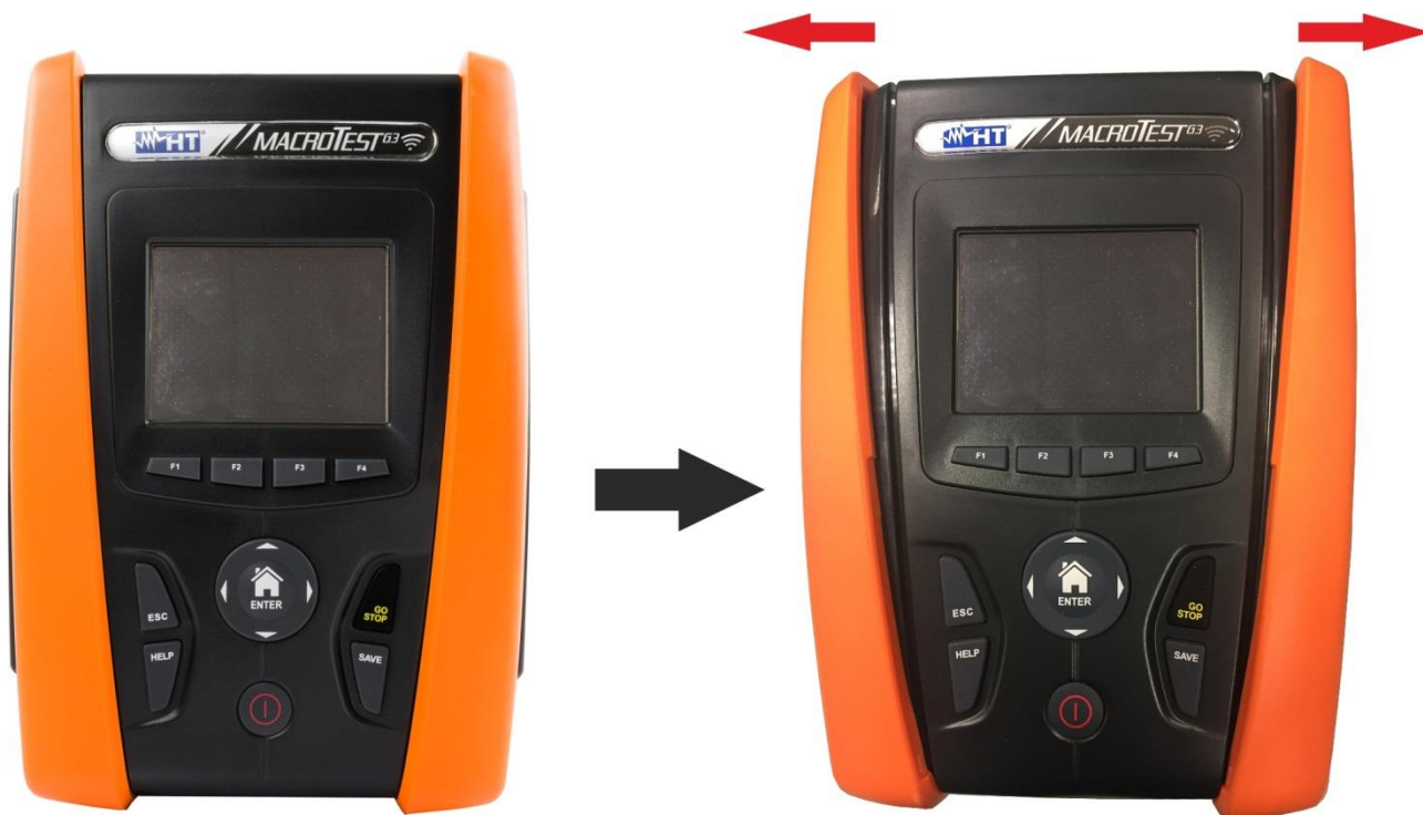
Fig. 40: Desmontagem das peças hemisféricas laterais
