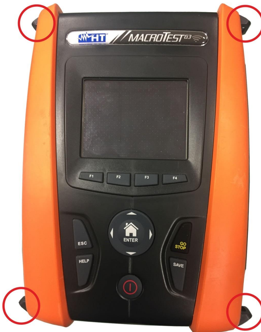
Fig. 42: Instrumento com peças hemisféricas e ganchos montados
