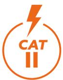
Mesures effectuées sur des circuits directement reliés à l'installation à basse tension
