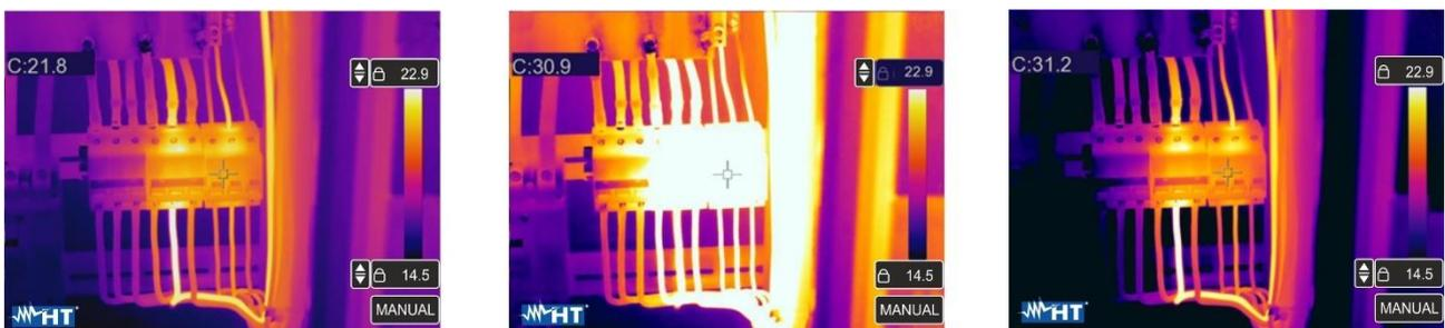
Fig. 47: Réglage du mode Manuel
