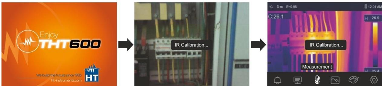
Fig. 5: Séquence de mise sous tension de l'instrument
