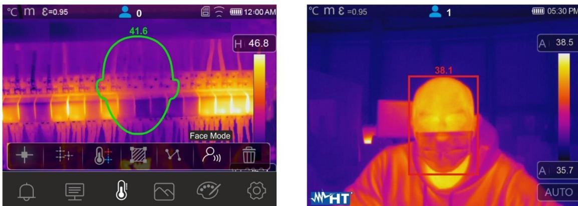
Fig. 54: Affichage des conditions d'alarme dans la fonction Screening
