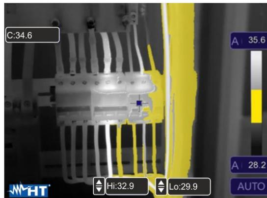
Fig. 43: Sélection isotherme Alarme intervalle de température
