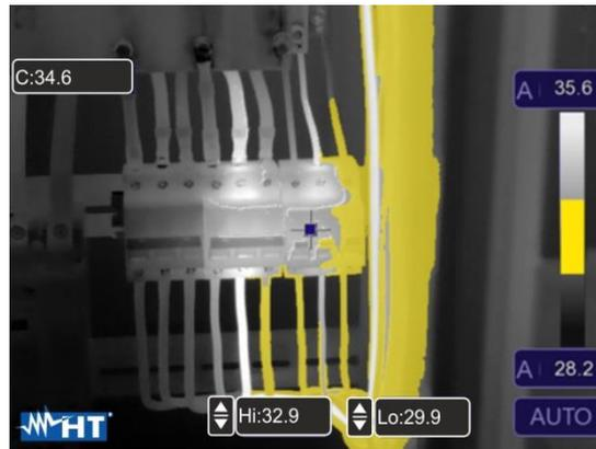
Fig. 39: Sélection isotherme Alarme intervalle de température
