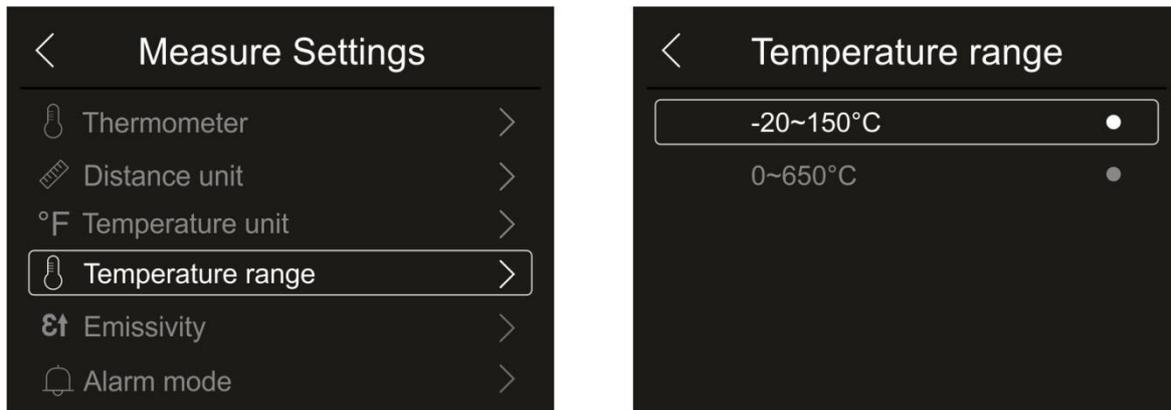
Fig. 24: Menu de réglage de la plage de mesure de la température
