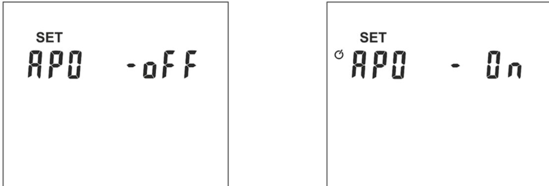
Fig. 3: Configuration arrêt automatique (APO)
