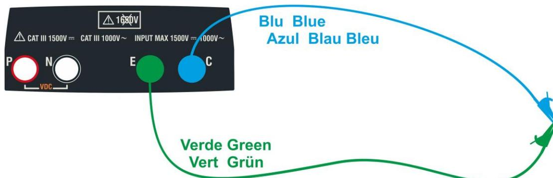
Fig. 4: Compensation de la résistance des câbles de mesure
