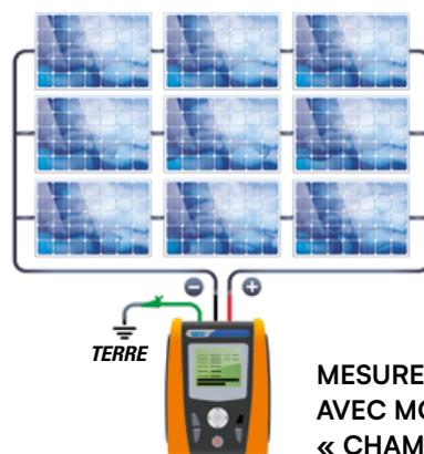
MESURE D'ISOLEMENT AVEC MODE « CHAMP ENTIER » PHOTOVOLTAÏQUE
