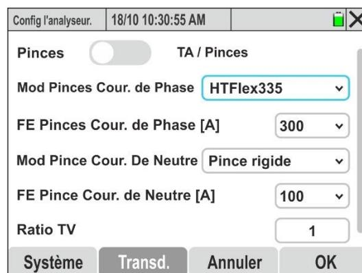
Fig. 21: Réglages des transducteurs de courant et de leurs FE
