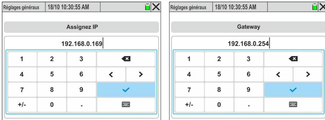
Fig. 17: Réglage des paramètres réseau Ethernet – Mode Défini par l'utilisateur
