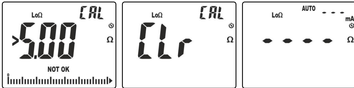
Fig. 34: Résultats remise à zéro pas exécutée correctement
