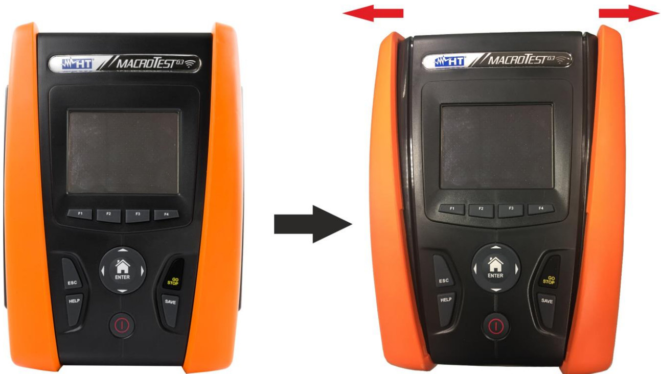
Fig. 40: Démontage des demi-coquilles latérales
