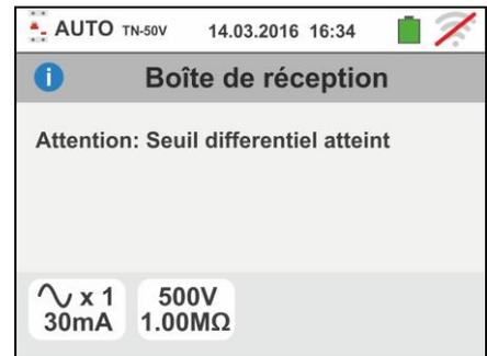
9. Si l'instrument détecte un potentiel dangereux sur le conducteur PE, il bloque l'essai et affiche le message ci-contre. Contrôler l'efficacité du conducteur PE et de l'installation de terre. **Ce message peut apparaître également lors d'une trop faible pression de la touche GO/STOP**
