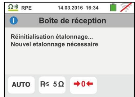
4. S'il est détecté que la résistance calibrée est supérieure à la résistance mesurée (par exemple pour l'utilisation de câbles autres que ceux fournis), l'instrument émet un signal acoustique prolongé et affiche un écran comme celui à côté. Effectuer une réinitialisation et effectuer un nouvel étalonnage
