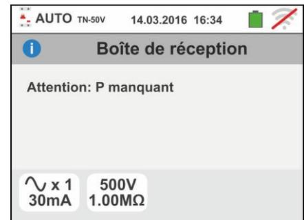
4. Si l'instrument détecte l'absence du signal à la borne B4 (conducteur de neutre), il affiche la page-écran d'avertissement ci-contre et bloque l'exécution des essais
