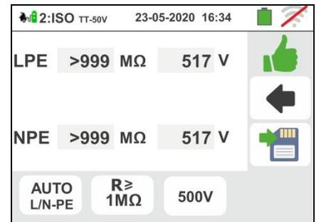
14 **Pour les systèmes EVSE triphasés**, le résultat de la mesure du **premier test L1PE** est affiché sur l'écran ci-contre. Les valeurs des tensions de test réelles sont affichées à l'écran. Le symbole
