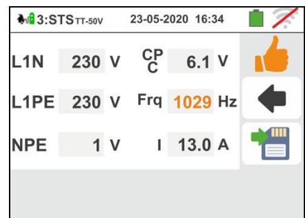
33 Si le test échoue, l'écran ci-contre s'affiche à l'écran. La valeur erronée du paramètre est indiquée en rouge et le symbole indique le résultat non correct de la mesure.
