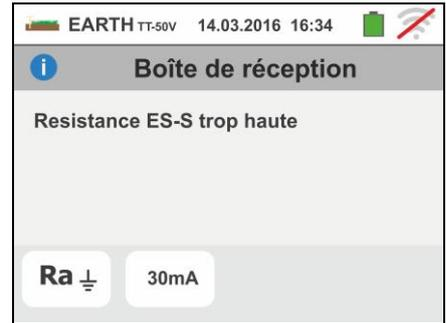
3. Au démarrage de la mesure, l'instrument vérifie la continuité des câbles de mesure. **Si le circuit ampérométrique (câbles bleu H et noir E) est interrompu ou a une résistance trop élevée**, l'instrument affiche une page-écran comme celle ci-contre.
