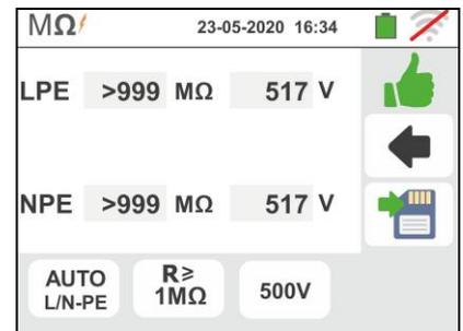
9. A la fin de l'essai, si la valeur de la résistance mesurée dans un ou les deux tests résulte inférieure à la limite réglée, la page-écran ci-contre est affichée.
