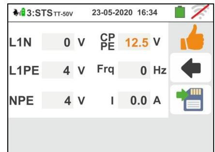
41 Si le test échoue, l'écran ci-contre s'affiche à l'écran. La valeur erronée du paramètre est indiquée en rouge et le symbole indique le résultat non correct de la mesure.
