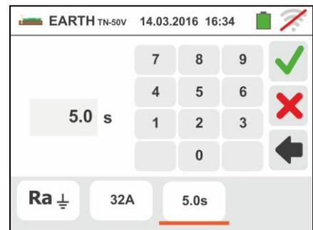
Sur la base des sélections précédentes, l'instrument exécute le calcul de la limite maximum de la résistance de terre en fonction de la valeur de la tension de contact maximum admise (voir la § 13.12) qui sera comparée avec la valeur mesurée afin de fournir le résultat final positif ou négatif de la mesure.
