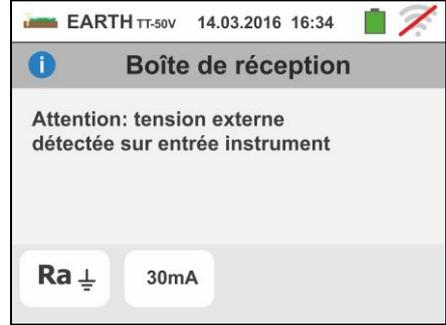
2. Au démarrage de la mesure, l'instrument vérifie la continuité des câbles de mesure. **Si le circuit voltmétrique (câbles rouge S et vert ES) est interrompu ou a une résistance trop élevée**, l'instrument affiche une page-écran comme celle ci-contre.
