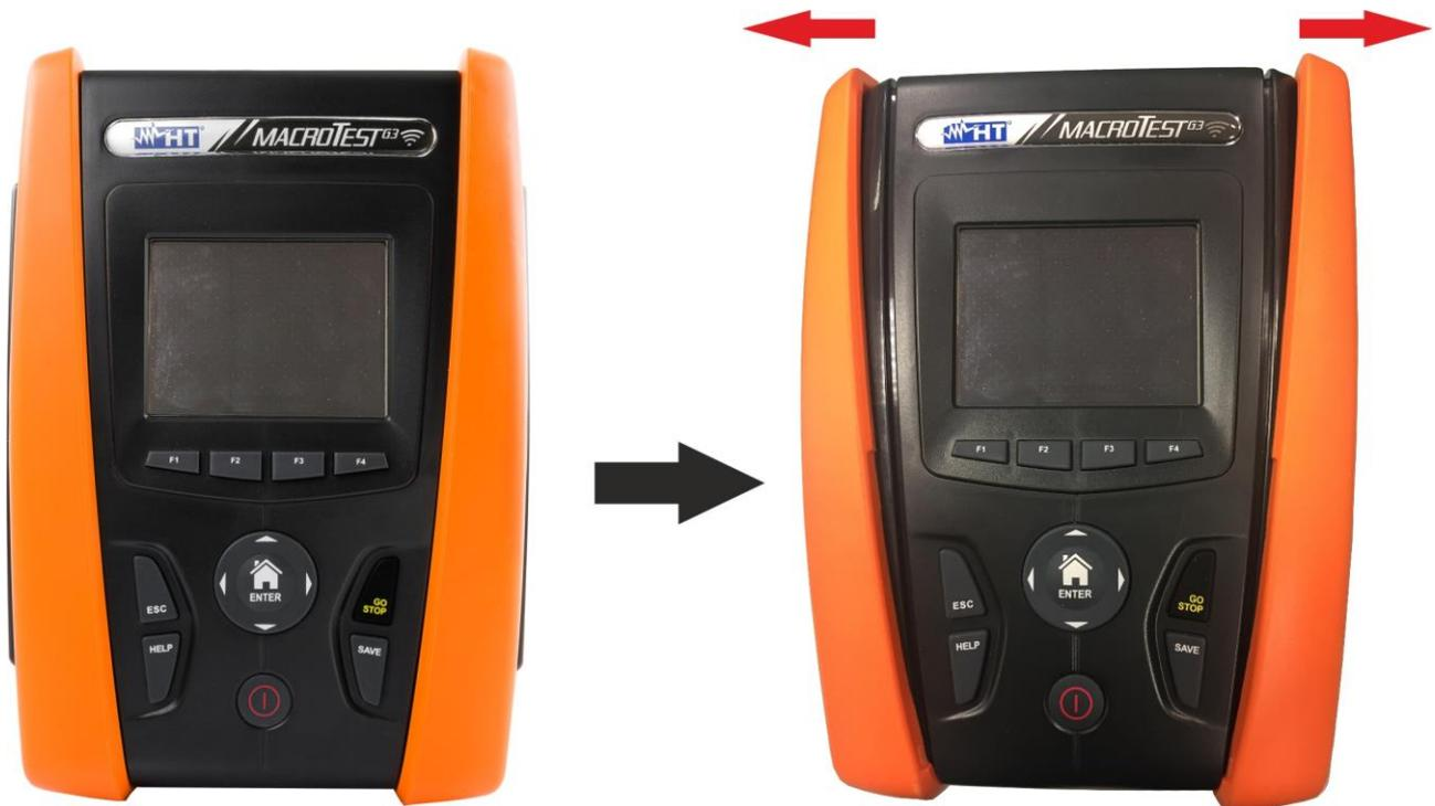
Fig. 40: Démontage des demi-coquilles latérales
