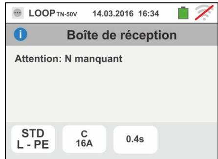
5. Si l'instrument détecte l'absence du signal à la borne B3 (conducteur PE), il affiche la page-écran d'avertissement ci-contre et bloque l'exécution des essais.
