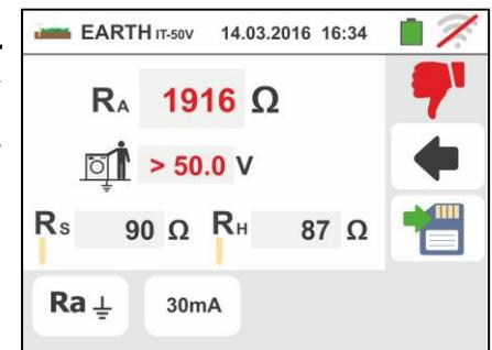
9. Pour la **mesure de résistance de terre dans les systèmes TN**, en cas de résultat **positif** (valeur mesurée INFÉRIEURE à la valeur limite) la page-écran ci-contre est montrée par l'instrument où se trouve la valeur de la résistance de contact de la sonde de tension ( $R_s$ ) et la valeur de la résistance de contact de la sonde de courant ( $R_h$ ).
