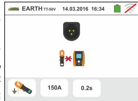
2. Connecter la pince T2100 en insérant le connecteur dans l'entrée **In1** de l'instrument. Allumer la pince et la mettre en mode « RS232 » (voir le manuel d'utilisation de la pince). Le symbole  $\Omega^5$  s'affiche à l'écran de la pince. **Dans ces conditions, le groupe instrument-pince est déjà prêt pour exécuter les mesures.** La page-écran suivante est montrée sur l'afficheur de l'instrument.
