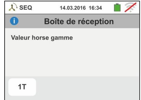
3. Si l'on détecte une fréquence de la tension d'entrée supérieure à la plage admise, l'instrument affiche une page-écran comme celle ci-contre.
