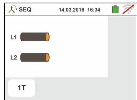
2. Déplacer la référence de la barre de glissement sur la position « 1T » pour la sélection de l'essai à 1 borne ou sur « 2T » pour la sélection de l'essai à 2 bornes.
