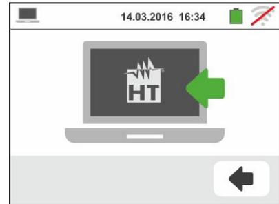
Dans cet état, l'instrument est en mesure de communiquer avec le PC par port USB.
