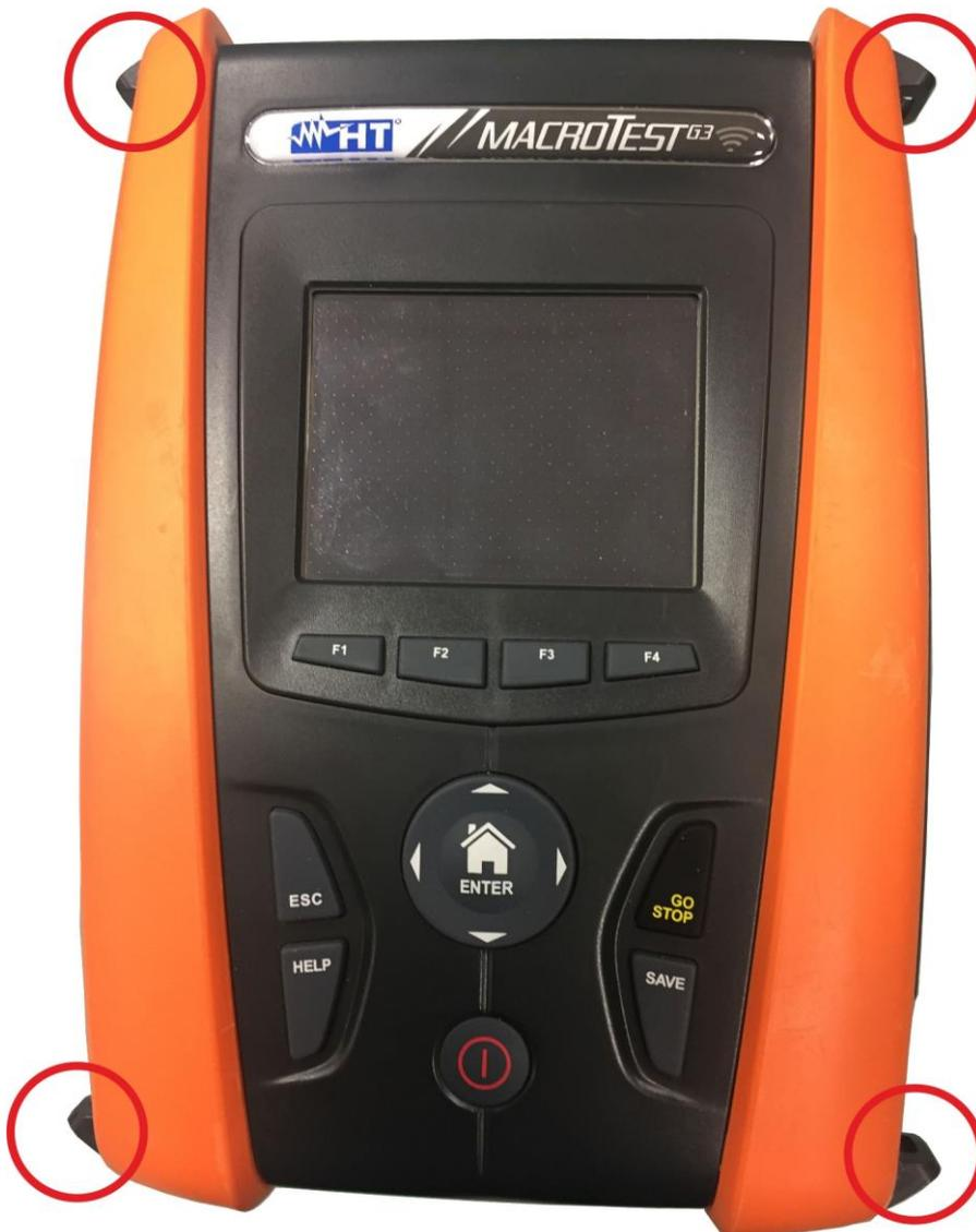
Fig. 42: Instrument avec demi-coques et crochets montés
