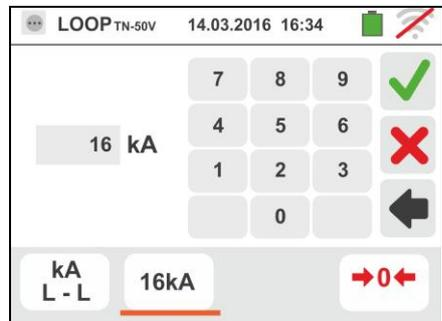
4. Déconnecter, lorsque cela est possible, toutes les charges connectées en aval du point de mesure car l'impédance des utilisateurs ci-dessus pourrait influencer les résultats de l'essai. Effectuer l'étalonnage préliminaire des cordons de test comme décrit dans le § 6.4.2 Connecter la fiche shuko, les crocodiles ou l'embout à distance au réseau électrique comme d'après les Fig. 18, Fig. 19, Fig. 20 et Fig. 22 le point le plus près possible de la protection en cours d'examen
