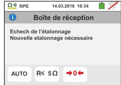
3. Si une réinitialisation de l'étalonnage du câble est effectuée (en exécutant l'opération les bornes ouvertes) l'instrument émet un signal sonore prolongé et montre une page-écran comme celle ci-contre. L'icône 📶 est affichée à l'écran pour indiquer la valeur mise à zéro de la calibration.
