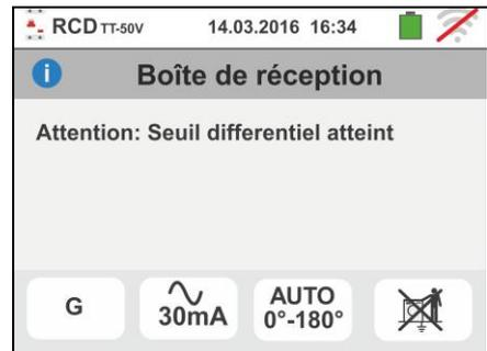
9. Si l'instrument détecte un potentiel dangereux sur le conducteur PE, il bloque l'essai et affiche le message ci-contre. Contrôler l'efficacité du conducteur PE et de l'installation de terre. Ce message peut apparaître également lors d'une trop faible pression de la touche **GO/STOP**
