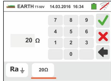
6. Appuyer sur la touche **GO/STOP**. Tout au long de cette phase, ne pas déconnecter les bornes de mesure de l'instrument de l'installation sous test. Le symbole
