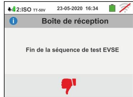
**Test 3 → Contrôle des états du système EVSE**
