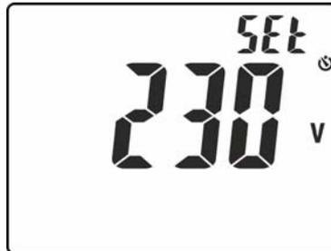
Fig. 6: Configuration de la tension nominale dans les mesures de Loop
