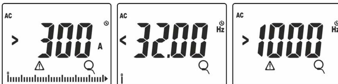
Fig. 41: Situations anormales sur la mesure de courant avec transducteurs à pince
