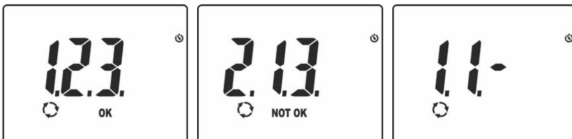
Fig. 16: Résultats de l'essai de séquence et de concordance des phases.
