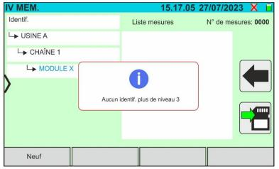
Avec le marqueur de troisième niveau sélectionné, en appuyant sur la touche « Neuf », l'instrument affiche l'image sur le côté et n'effectue pas l'opération. Il n'est pas possible de définir des marqueurs au-delà du troisième niveau
