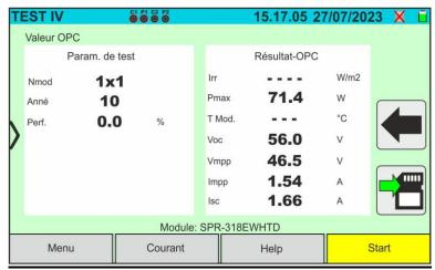
Fig. 38: Résultat de mesure de la Courbe I-V sans unité distante
