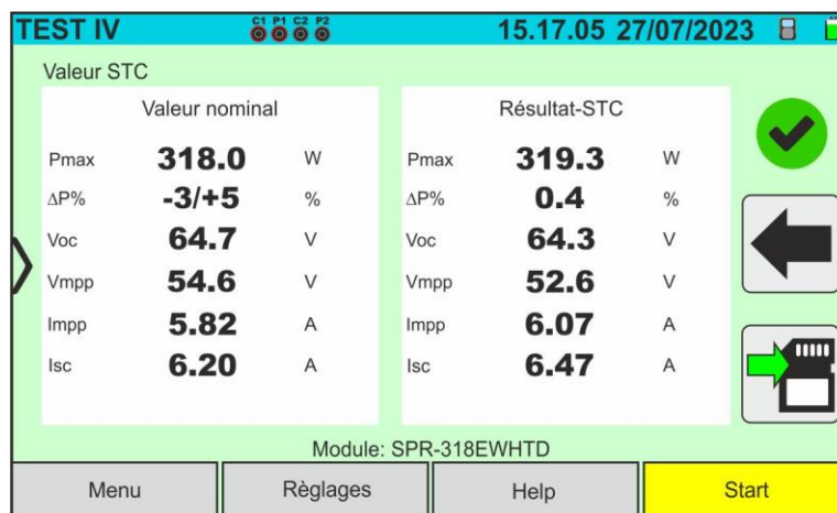
Fig. 43 : Exemple de résultat mesure courbe I-V – Valeurs STC
