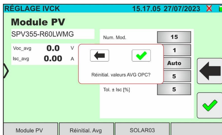
Fig. 60 : Réinitialisation des valeurs moyennes Voc et Isc dans le test IVCK
