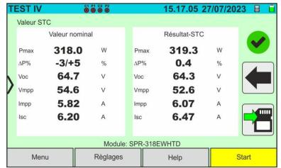
Fig. 43 : Exemple de résultat mesure courbe I-V – Valeurs STC 13.Les paramètres suivants sont affichés à l'écran du résultat de mesure :
