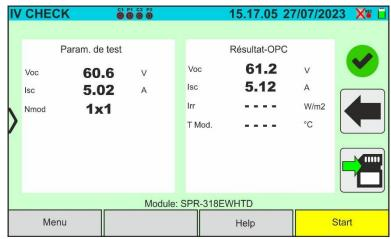
Fig. 77: Résultat mesure test IVCK @OPC avec enregistrement synchrone
