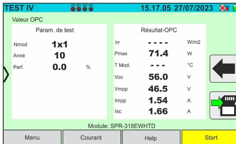
Fig. 54: Résultat mesure courbe I-V @OPC avec enregistrement synchrone
