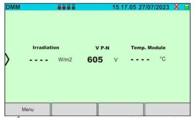
Fig. 14: Écran de mesure fonction DMM (SOLAR03 débranché)
