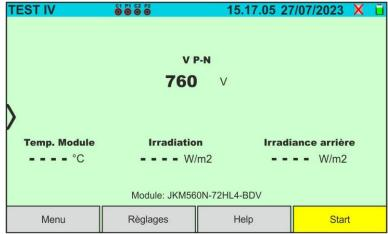
Fig. 36: Écran initial test I-V sans unité distante sur modules Biface
