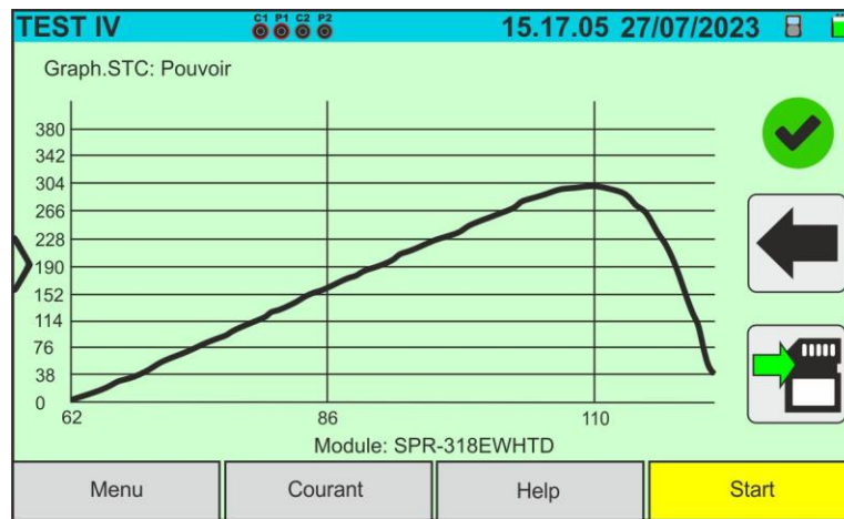
Fig. 46: Exemple de résultat mesure Puissance – Courbe STC
