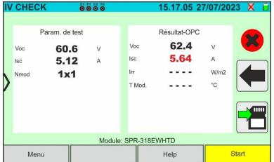
Fig. 63 : Exemple de résultat négatif test IVCK – Valeurs OPC
