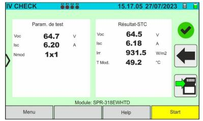
Fig. 68 : Exemple de résultat positif test IVCK – Valeurs STC
