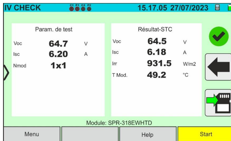
Fig. 67 : Exemple de résultat positif test IVCK – Valeurs STC
