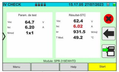
Fig. 69 : Exemple de résultat négatif test IVCK - Valeurs STC
