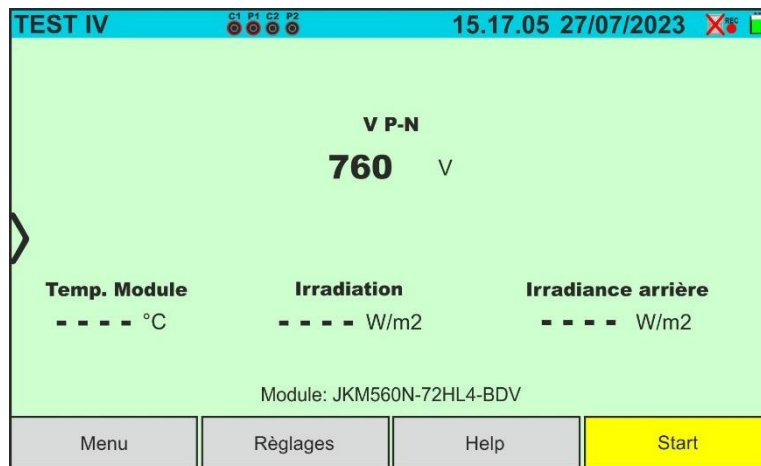
Fig. 52: Écran test I-V avec SOLAR03 en enregistrement synchrone en module Biface
