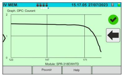
Fig. 93 : Rappel des résultats mesure courbe I-V – Courbe actuelle @OPC
