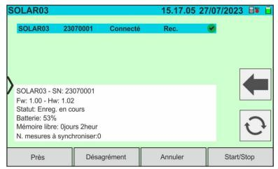
Fig. 73 : Activation de l'enregistrement sur l'unité à distance – Étape 2
