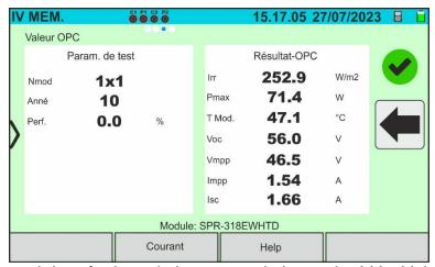
Fig. 92 : Rappel des résultats de la mesure de la courbe I-V – Valeurs @OTC
