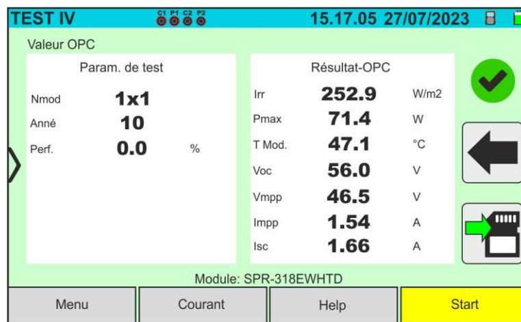
Fig. 44 : Exemple de résultat mesure courbe I-V – Valeurs OPC
