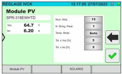
Fig. 67: Définition des paramètres de mesure de la courbe I-V
