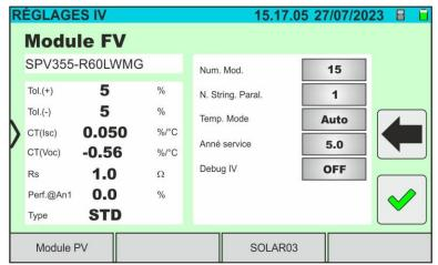
Fig. 42: Définition des paramètres de mesure de la courbe I-V
