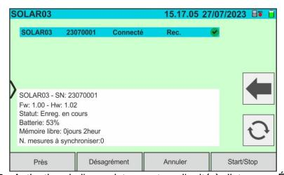
Fig. 50 : Activation de l'enregistrement sur l'unité à distance – Étape 2
