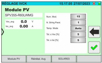
Fig. 60: Définition des paramètres test IVCK
