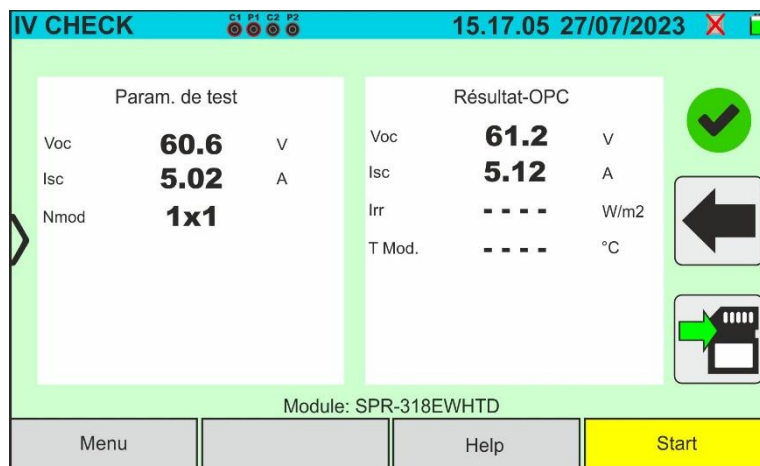
Fig. 61 : Exemple de résultat positif test IVCK – Valeurs OPC
