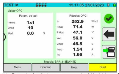
Fig. 44 : Exemple de résultat mesure courbe I-V – Valeurs OPC
