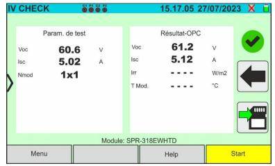
Fig. 62 : Exemple de résultat positif test IVCK – Valeurs OPC
