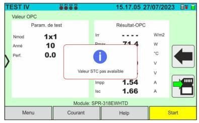
Si, pendant l'exécution d'une mesure I-V ou IVCK, l'instrument ne parvient pas à déterminer les valeurs @STC, il affiche le message sur l'écran ci-contre. Vérifiez que vous disposez d'une irradiation stable, ainsi que du bon dépassement du seuil minimum et que vous avez effectué la mesure conformément aux indications de l'accessoire M304 (voir § 6.4.2 – point 10). Répétez les mesures à d'autres moments de la journée nécessaire
