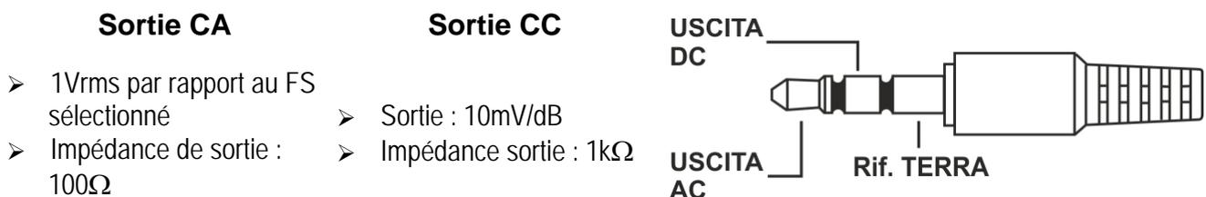
Fig. 10: Caractéristique sortie analogique CA/CC
