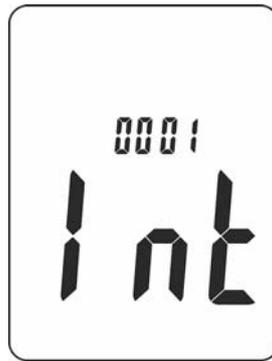
Fig. 7 : Configuration intervalle d'échantillonnage
