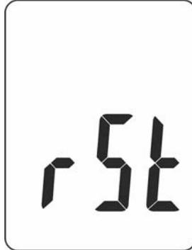
Fig. 5 : Activation de la réinitialisation (reset) de l'instrument
