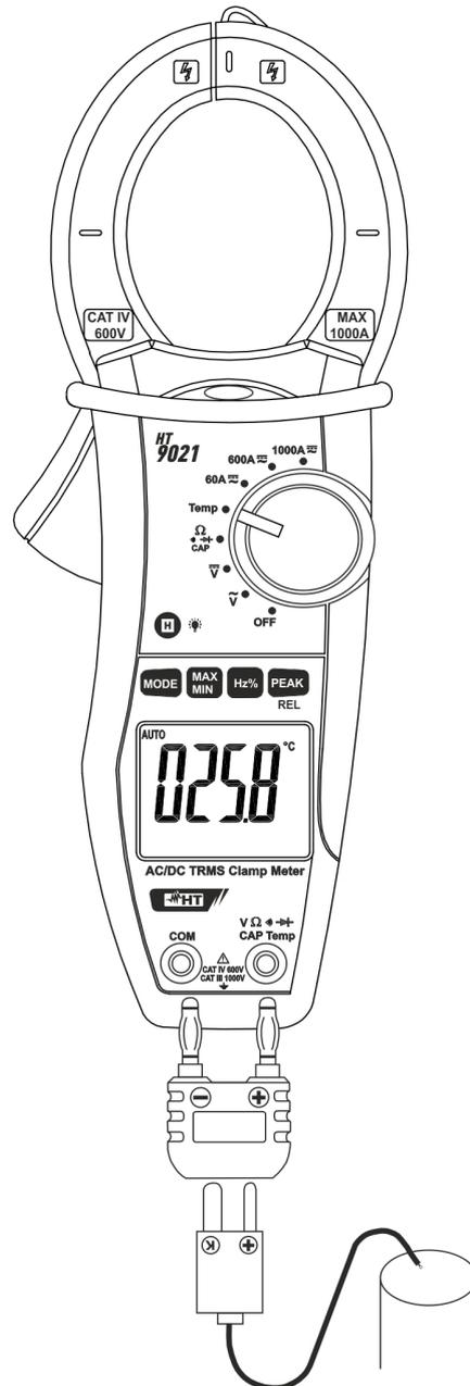
Fig. 8 : Utilisation de la pince pour mesure de température
