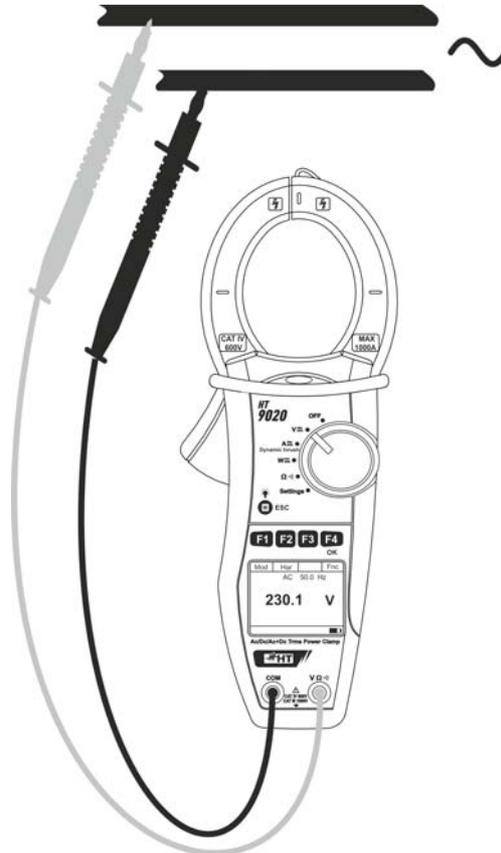
Fig. 6 : Mesure de tension AC/AC+DC
