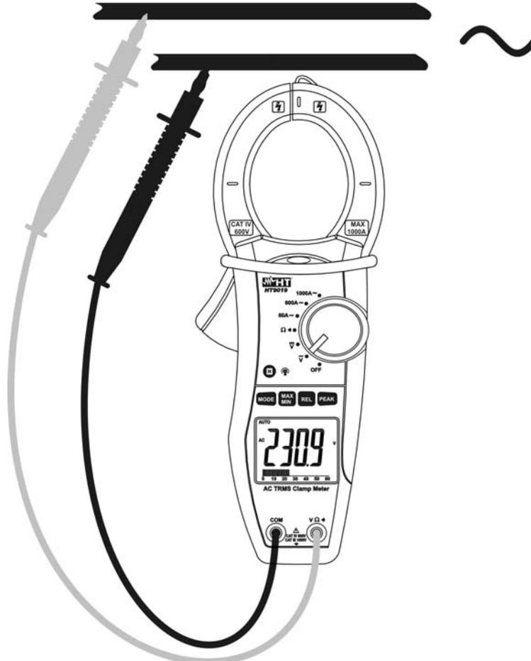
Fig. 3 : Utilisation de la pince pour mesures de tension AC
