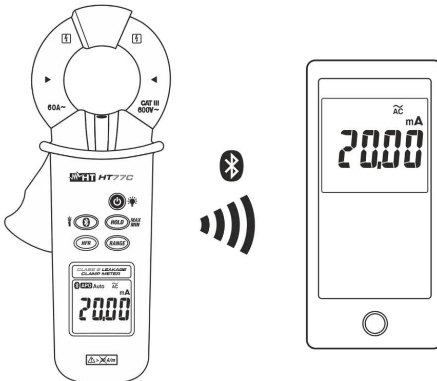
Fig. 8: Conexión del instrumento al dispositivo móvil
