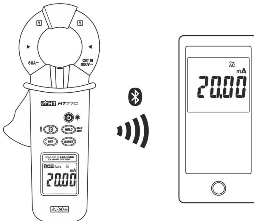
Fig. 8: Conexão do instrumento ao dispositivo móvel
