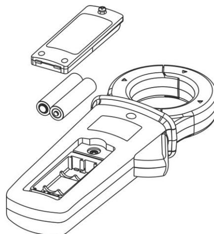
Fig. 9: Sustitución pilas
