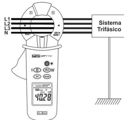
Fig. 6: Medição correntes de fuga pelo método direto em sistemas Trifásicos
