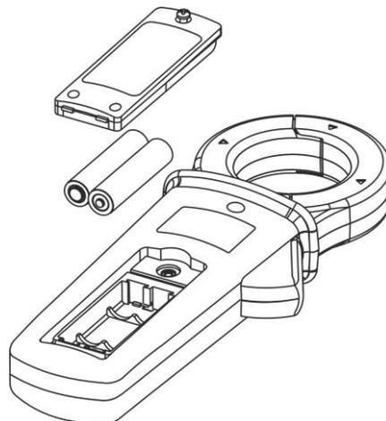
Fig. 9: Sostituzione batterie
