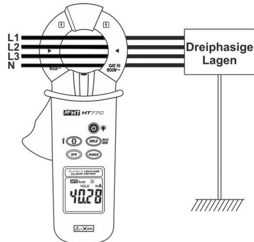
Abb. 6: Messung Leckstrom mit der direkten Methode auf Dreiphasige Lagen
