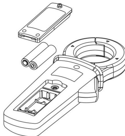
Abb. 9: Batteriewechsel
