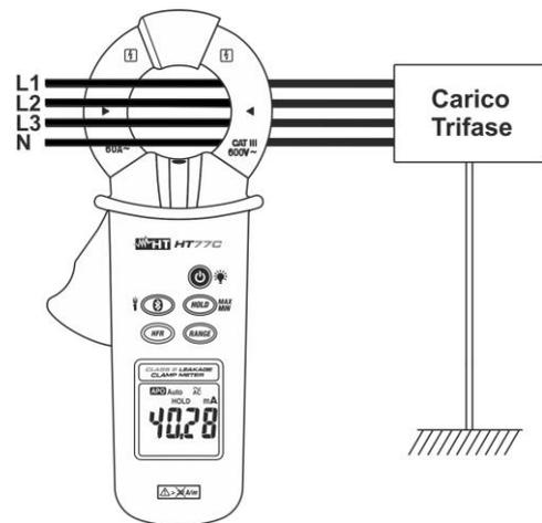
Fig. 6: Misura corrente di dispersione con metodo diretto in sistemi Trifase
