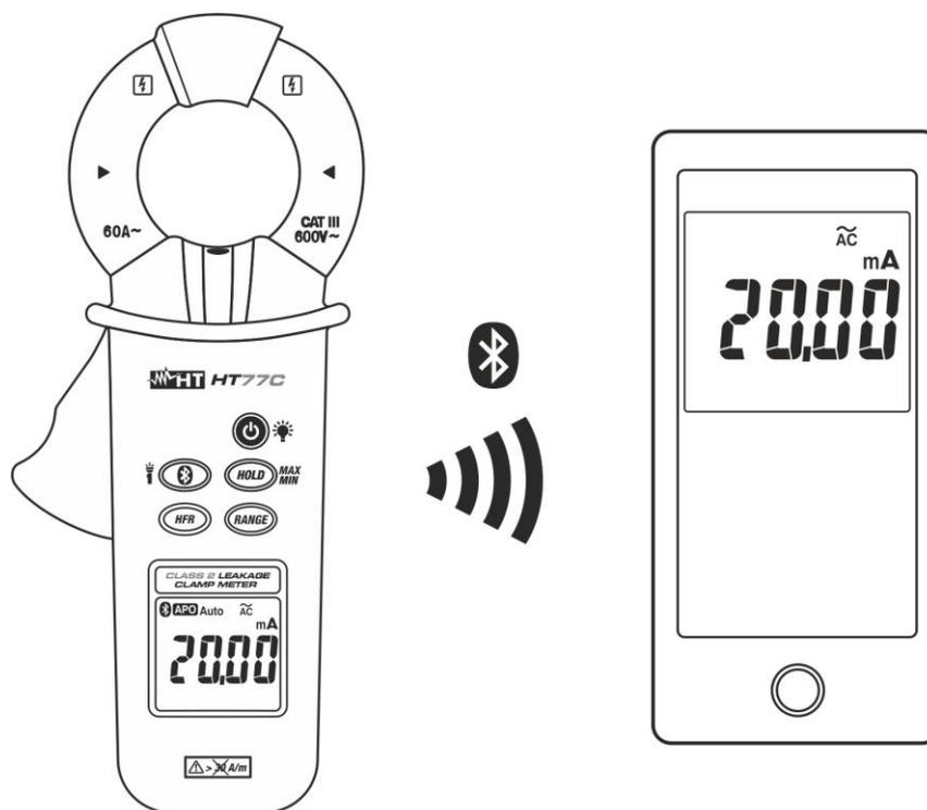
Abb. 8: Verbindung des Instrument zu mobilen Geräten
