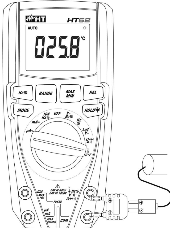
Abb. 9: Verwendung des Gerätes für Temperaturmessung
