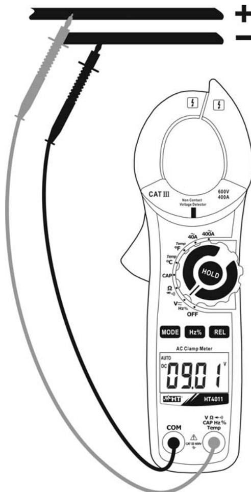
Fig. 2 : Utilisation de la pince pour mesure de tension DC
