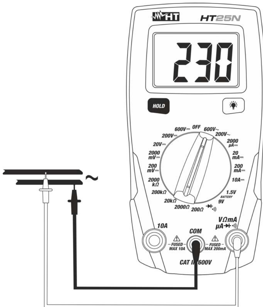
Fig. 3 : Utilisation de l'instrument pour mesure de tension AC
