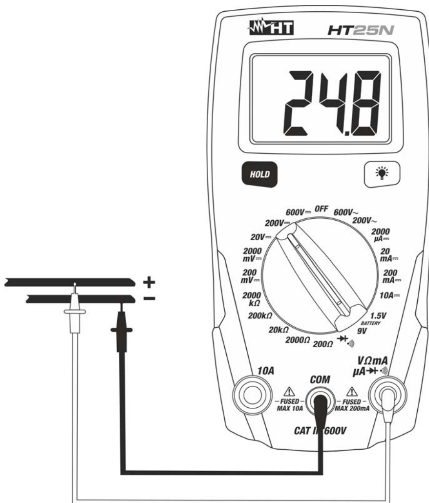
Fig. 2 : Utilisation de l'instrument pour mesure de tension DC
