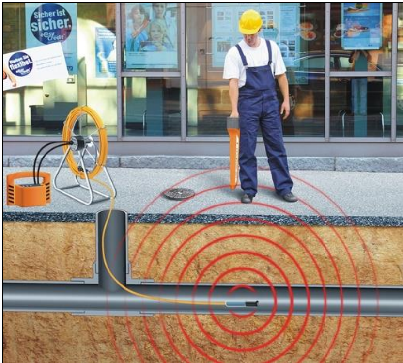
Fig. 9: Localizzazione di servizi non metallici
