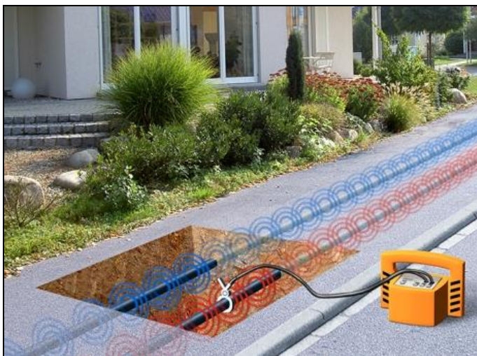
Fig. 6: Accoppiamento tramite pinza a induzione
