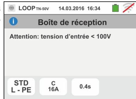
3. Si l'instrument détecte l'absence du signal à la borne B1 (conducteur de phase), il affiche la page-écran d'avertissement ci-contre et bloque l'exécution des essais.
