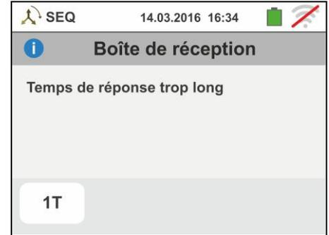
2. Si l'on détecte une tension d'entrée supérieure à la limite maximum, l'instrument affiche une page-écran comme celle ci-contre.
