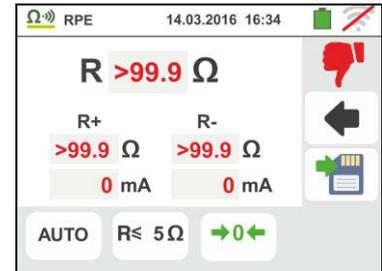
12. A la fin du test dans la fonction ")))" si la valeur de la résistance mesurée est supérieure à la limite réglée, la valeur est indiquée en rouge. L'indication "> 1999Ω" indique l'échelle hors échelle de l'instrument comme indiqué sur l'écran à côté
