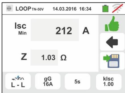
9. En cas de résultat négatif (le courant de court-circuit minimum N'est PAS coupé par le dispositif de protection dans le temps indiqué dans les sélections effectuées), la page-écran ci-contre est affichée par l'instrument.
