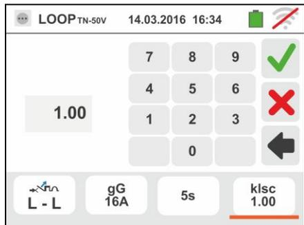
7. Déconnecter, lorsque cela est possible, toutes les charges connectées en aval du point de mesure car l'impédance des utilisateurs ci-dessus pourrait influencer les résultats de l'essai. Connecter la fiche shuko, les crocodiles ou l'embout à distance au réseau électrique comme d'après les Fig. 17, Fig. 18, Fig. 19 et Fig. 21 le point le plus près possible de la protection en cours d'examen
