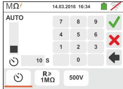
4. Toucher l'icône « R ≥ xxΩ » pour régler la valeur limite minimum de la résistance d'isolement sur laquelle l'instrument exécute la comparaison avec la valeur mesurée. La page-écran ci-contre est affichée.
