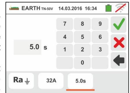
Sur la base des sélections précédentes, l'instrument exécute le calcul de la limite maximum de la résistance de terre en fonction de la valeur de la tension de contact maximum admise (voir la § 13.11) qui sera comparée avec la valeur mesurée afin de fournir le résultat final positif ou négatif de la mesure.
