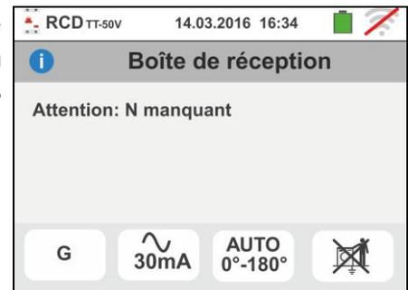
5. Si l'instrument détecte l'absence du signal à la borne B3 (conducteur PE), il affiche la page-écran d'avertissement ci-contre et bloque l'exécution des essais.
