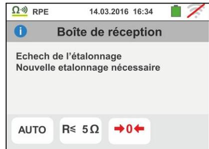
3. Au cas où l'on détecterait que la résistance calibrée est plus élevée que la résistance mesurée, l'instrument émet un signal sonore prolongé et montre une page-écran comme celle ci-contre. L'icône →0← est affichée à l'écran pour indiquer la valeur mise à zéro de la calibration.
