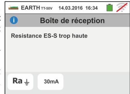
3. Au démarrage de la mesure, l'instrument vérifie la continuité des câbles de mesure. **Si le circuit ampérométrique (câbles bleu H et noir E) est interrompu ou a une résistance trop élevée**, l'instrument affiche une page-écran comme celle ci-contre.
