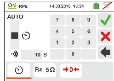
4. Toucher l'icône «  $R \leq xx\Omega$  » pour régler la valeur limite maximum de la résistance sur laquelle l'instrument exécute la comparaison avec la valeur mesurée. La page-écran ci-contre est affichée.
