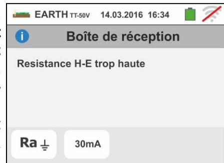
4. Au démarrage de la mesure, l'instrument vérifie l'état des douilles B2 (S) et B3 (ES). En cas d'inversion des conducteurs sur l'installation, l'instrument bloque l'essai et affiche le message ci-contre
