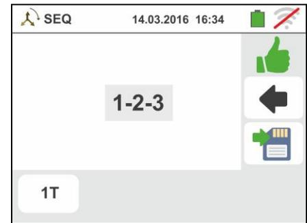
9. A la fin de l'essai, si les deux tensions détectées sont en phase (**concordance de phase entre deux systèmes triphasés distingués**), l'instrument affiche une page-écran comme celle ci-contre (résultat « 1-1- »)
