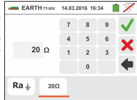
6. Appuyer sur la touche **GO/STOP**. Tout au long de cette phase, ne pas déconnecter les bornes de mesure de l'instrument de l'installation sous test. Le symbole
