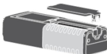
Fig. 9 : Remplacement de la batterie interne
