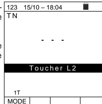
6. L'instrument émet un son prolongé tant que la tension d'entrée n'est pas présente. À la fin du test, si la séquence des phases détectée est **correcte**, l'instrument affiche une fenêtre-vidéo semblable à celle illustrée ci-contre (résultat "**123**") avec le message "**OK**"
