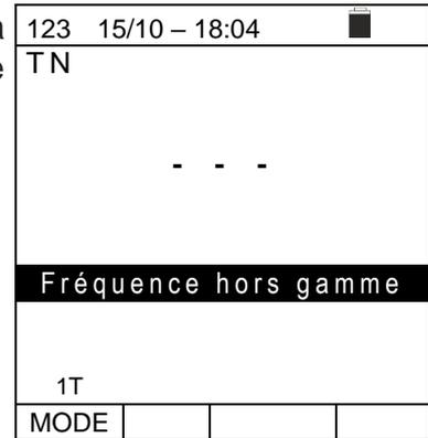
2. Si l'instrument détecte une tension en entrée L-PE supérieure à 265V, il affiche une fenêtre-vidéo semblable à celle illustrée ci-contre
