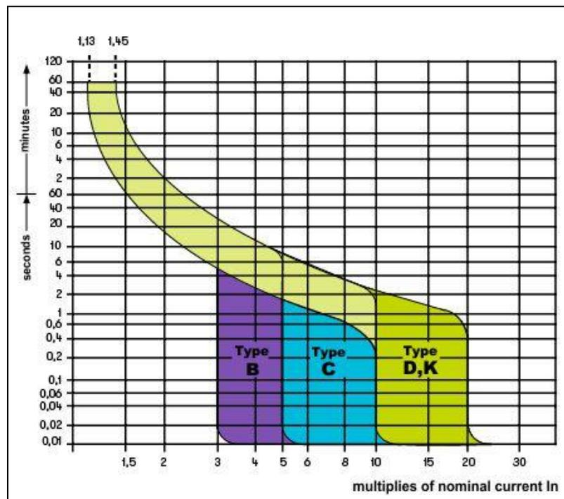
Fig. 41: Exemple de courbes d'intervention protections magnétothermiques (MCB)
