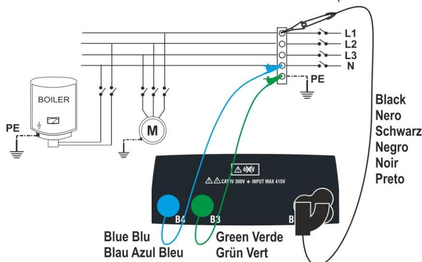
Fig. 14: Isolation entre L-N-PE avec des câbles individuels et une embout à distance (modes MAN et AUTO)
