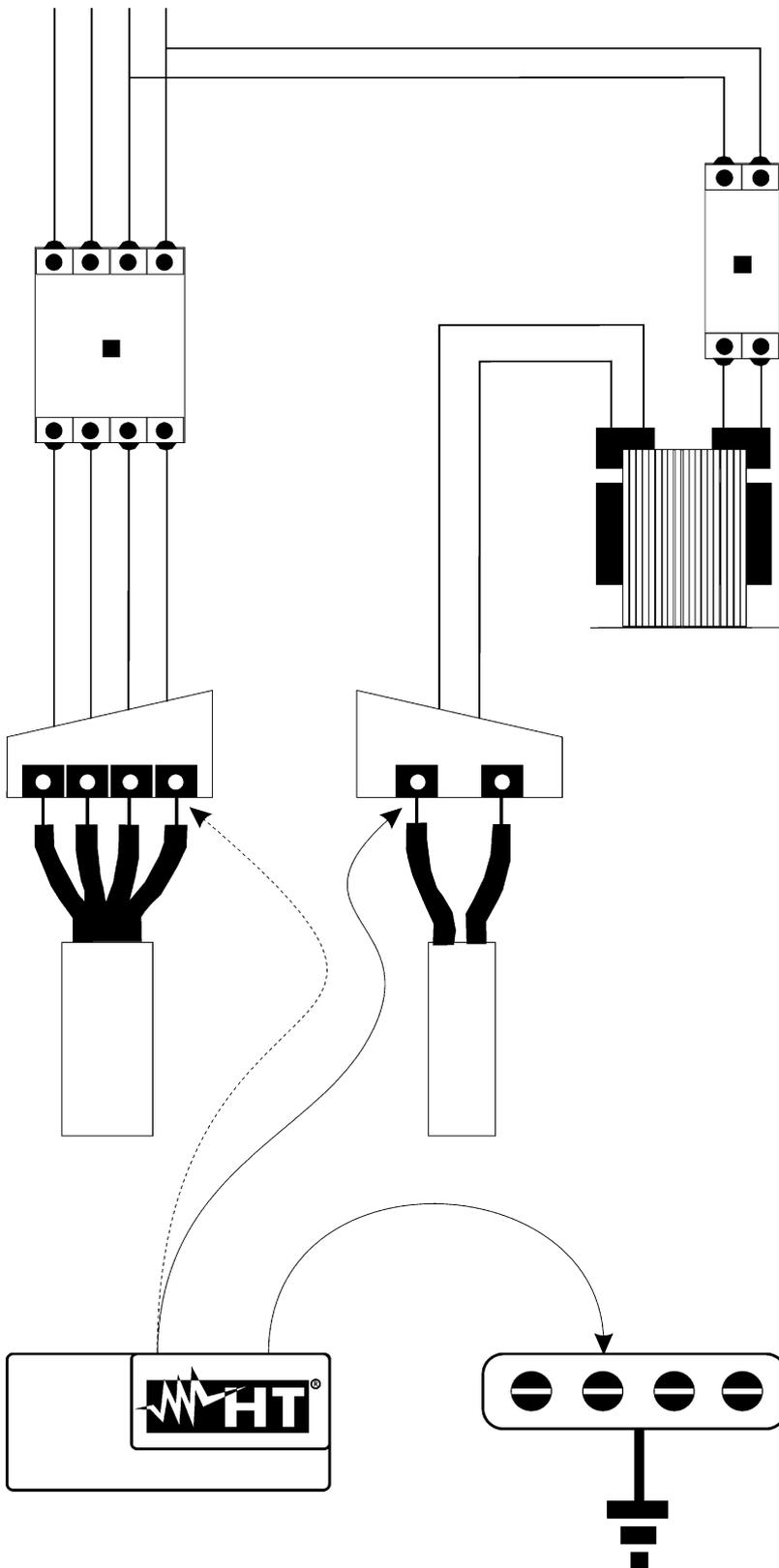
Transformateur d'isolation ou de sécurité qui effectue la séparation entre les circuits
