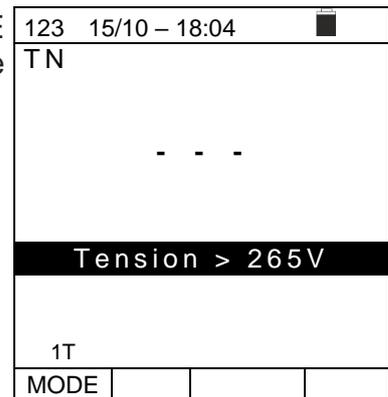
3. Si entre le début du test et l'acquisition de la première tension ou entre l'acquisition de la première et de la deuxième tension, il s'est écoulé un temps supérieur à environ 10s, l'instrument affiche une fenêtre-vidéo semblable à celle illustrée ci-contre. Il est nécessaire de répéter le test
