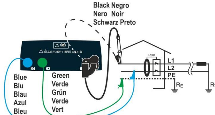
Fig. 22: Connexion pour système Biphase L1-L2-PE N avec câbles et embout à distance
