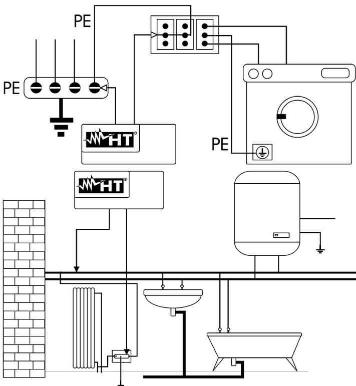
Raccorder l'une des aiguilles-sondes au conducteur de protection de la prise de force motrice et l'autre au nœud équipotentiel de l'installation de mise à la terre.
