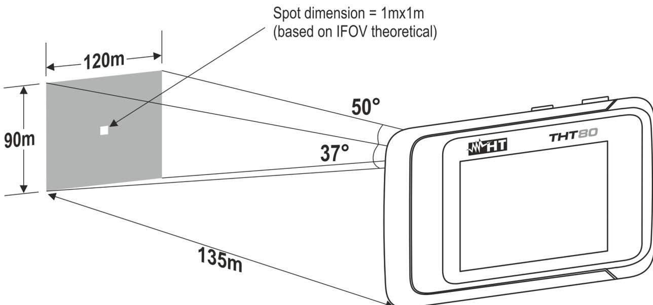
Fig. 50: Representación del rango visual FOV del instrumento
