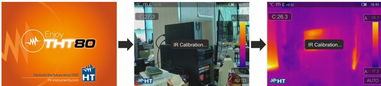
Fig. 6: Secuencia de encendido del instrumento
