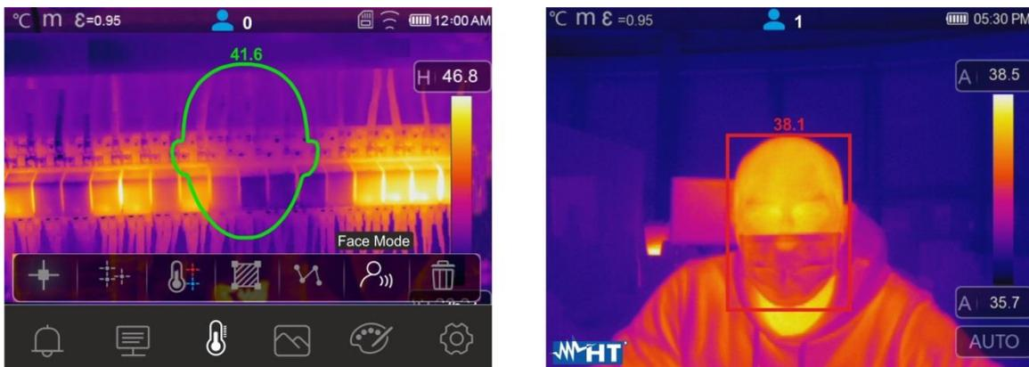
Fig. 54: Visualización condición de alarma en la función Screening
