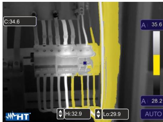
Fig. 43: Selección isoterma Alarm Temp. range
