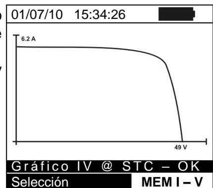
6. Con pantalla de los valores medidos por el instrumento seleccione la función “**Graf I-V**” con la tecla flecha ▼ y pulse **ENTER** o la tecla flecha ►
