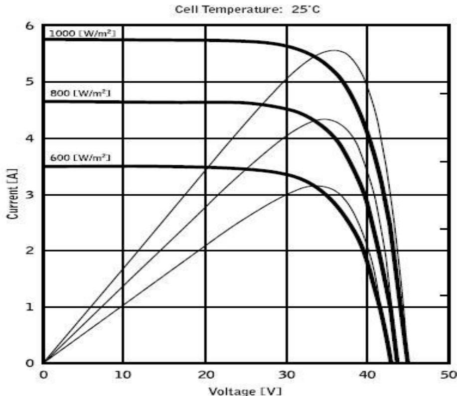
Sobre cada curva característica existe uno y un sólo punto el cual es maximizado la transferencia de potencia respecto a una hipotética carga alimentada por el módulo fotovoltaico. El punto de máxima potencia corresponde a la tensión-corriente siendo el producto máximo de  $V \cdot I$ , donde  $V$  es el valor de la tensión en bornes del módulo y la  $I$  es la corriente que circula en el circuito obtenido cerrando el módulo sobre una hipotética carga.
