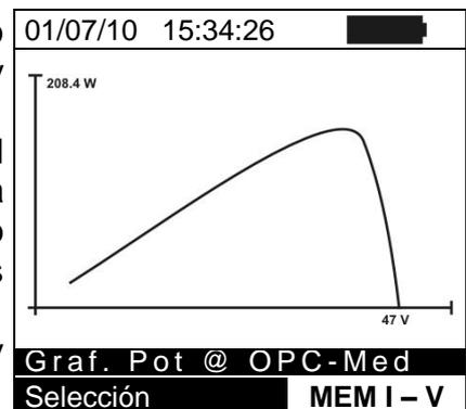
9. Con la pantalla de los valores medidos por el instrumento seleccione la función “**Graf P**” con la tecla flecha ▼ y pulse **ENTER** o la tecla flecha ►.
