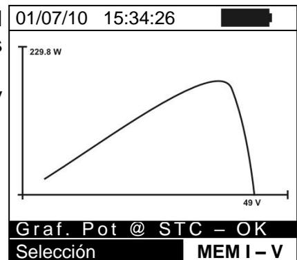
6. Con la pantalla de los valores medidos por el instrumento seleccione la función “**Graf P**” con la tecla flecha ▼ y pulse **ENTER** o la tecla flecha ►.
