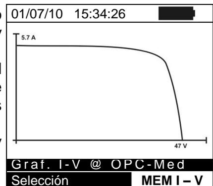
9. Con pantalla de los valores numéricos medidos por el instrumento seleccione la función “**Graf I-V**” con la tecla flecha ▼ y pulse **ENTER** o la tecla flecha ►
