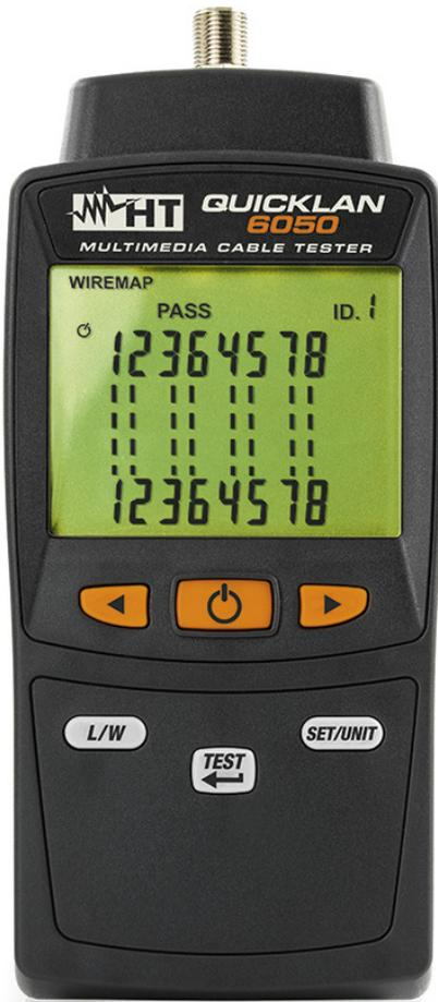
El instrumento portátil QUICKLAN6050 es capaz de obtener y indicar en pantalla la presencia de conexiones erróneas sobre cables de redes LAN (pares cruzados, divididos, invertidos, abiertos, en cortocircuito, etc...) tanto de tipo UTP (no apantallados) como de tipo STP o FTP (apantallados).
