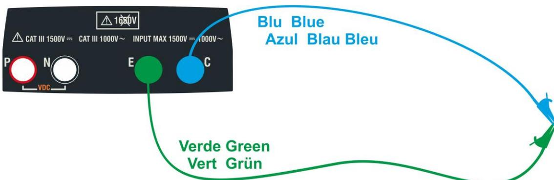
Fig. 4: Compensación de la resistencia de los cables de medida
