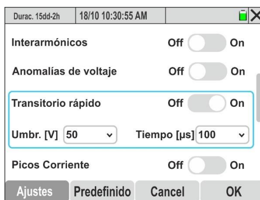
Fig. 33: Activación/desactivación registro transitorios de tensión rápidos (spikes)
