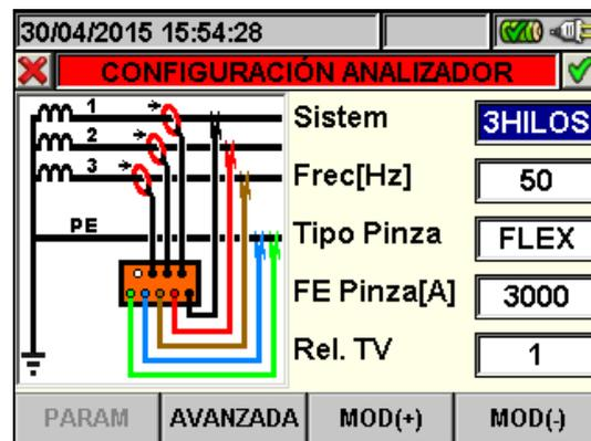
Fig. 45: Pantalla configuración analizador para sistema Trifásico 3-hilos
