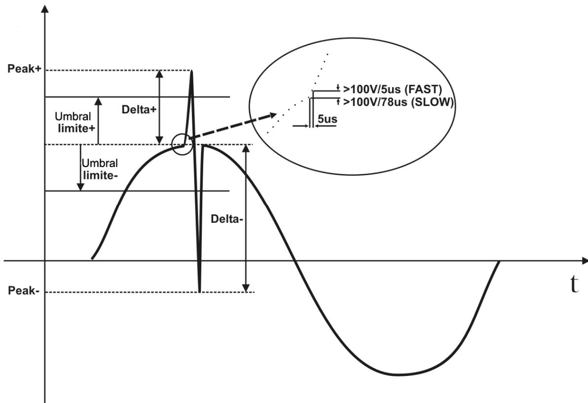
Fig. 133: Análisis spike de tensión completo a 50Hz
