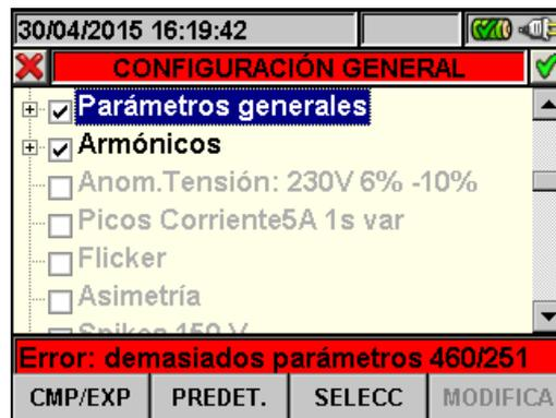
Fig. 59: Sección Parámetros Generales: Demasiados parámetros seleccionados
