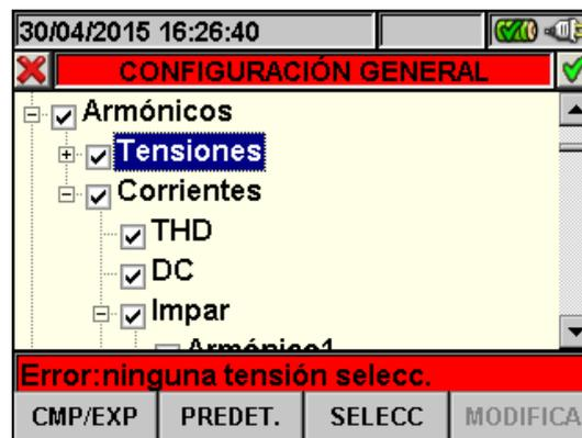
Fig. 64: Pantalla ninguna tensión seleccionada
