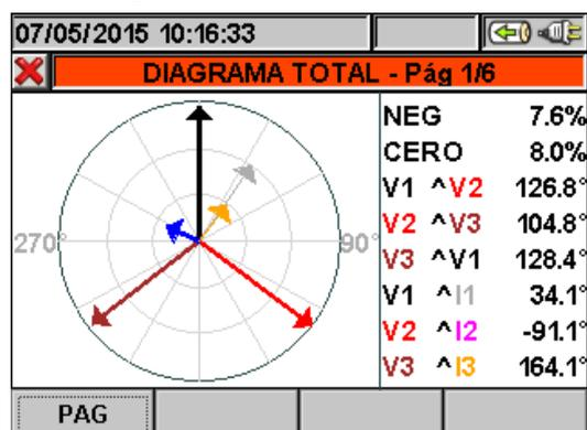
Fig. 40: Diagrama vectorial tensiones para sistema 4-hilos
