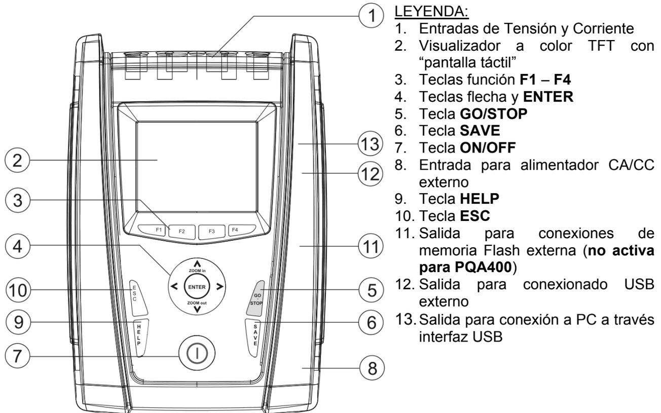
Fig. 1: Descripción parte frontal del instrumento
