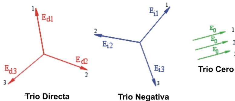
Fig. 132: Descomposición de un trio de vectores
