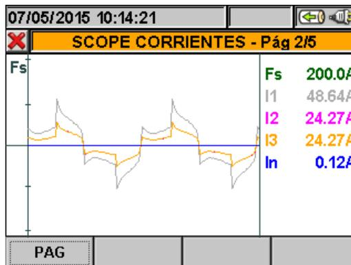
Fig. 29: Pantalla formas de onda de las corrientes para sistema trifásico 4-hilos
