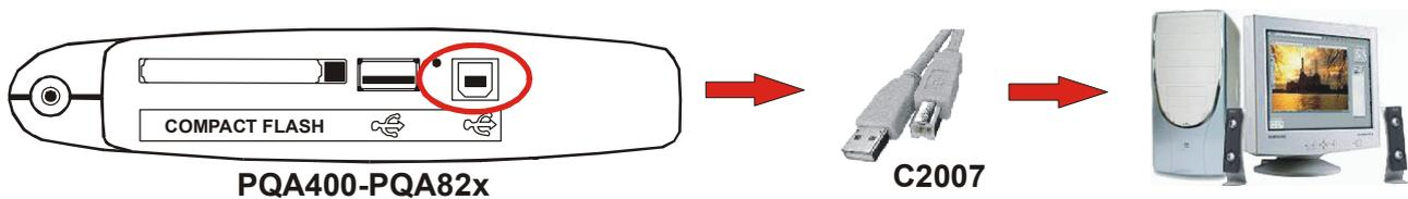
Fig. 119: Conexión del instrumento al PC
