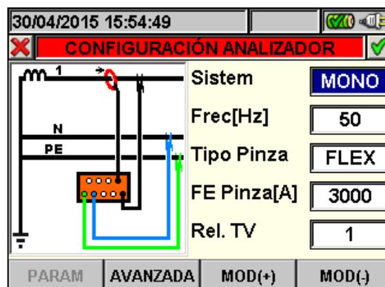
Fig. 47: Pantalla configuración analizador para sistema Monofásico
