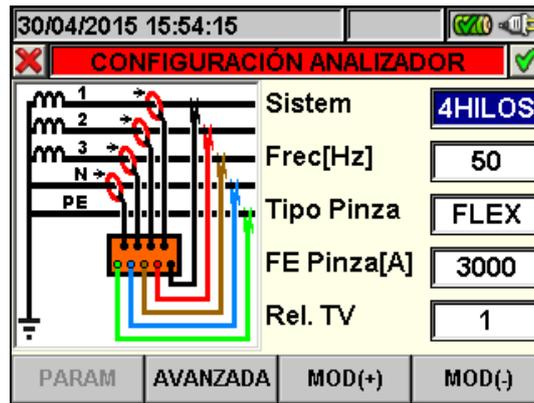
Fig. 44: Pantalla configuración analizador para sistema trifásico 4-hilos
