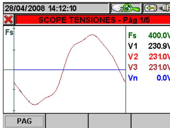
Fig. 107: Gráfico Tensiones en Sistema Trifásico 4 hilos
