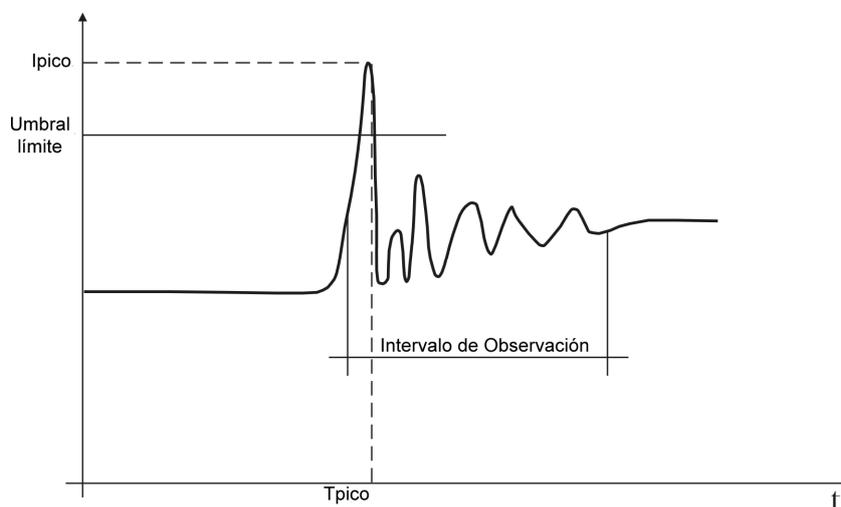
Fig. 131: Parámetro corriente de pico en arranque oscilante
