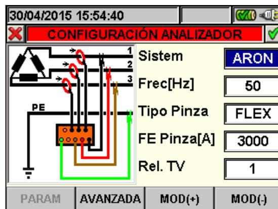
Fig. 46: Pantalla configuración analizador para sistema Trifásico ARON
