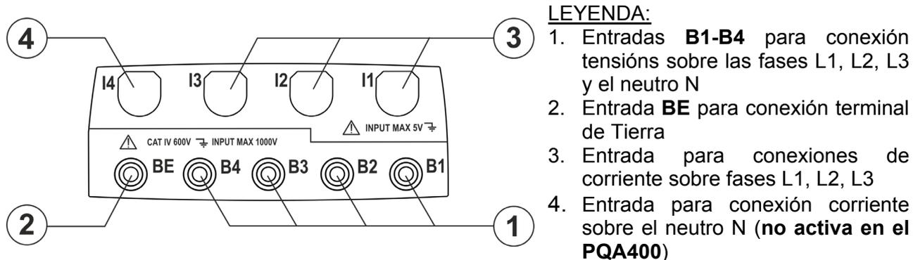
Fig. 2: Descripción terminales de entrada del instrumento
