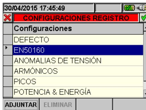
Fig. 74: Pantalla configuración predefinida
