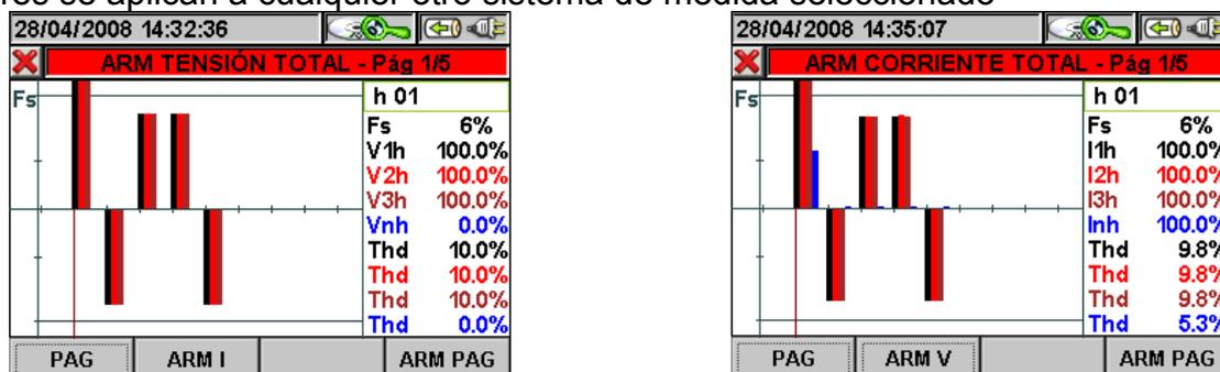
Fig. 108: Armónicos Totales en Sistema Trifásico 4 hilos
