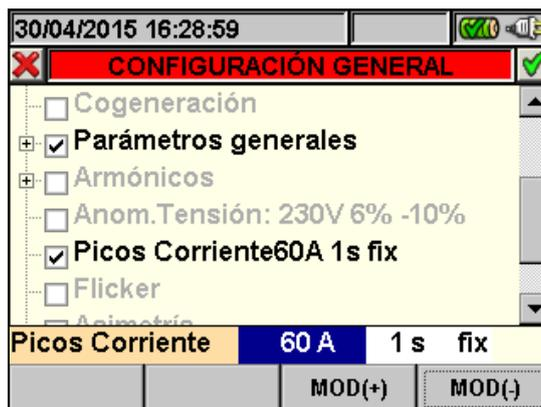
Fig. 68: Pantalla Corriente de pico - configuración parámetros
