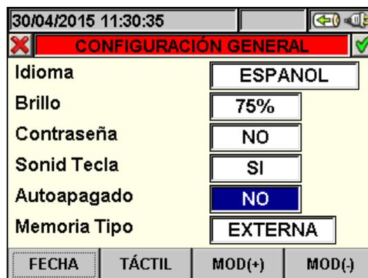
Fig. 15: Pantalla Programación Autoapagado
