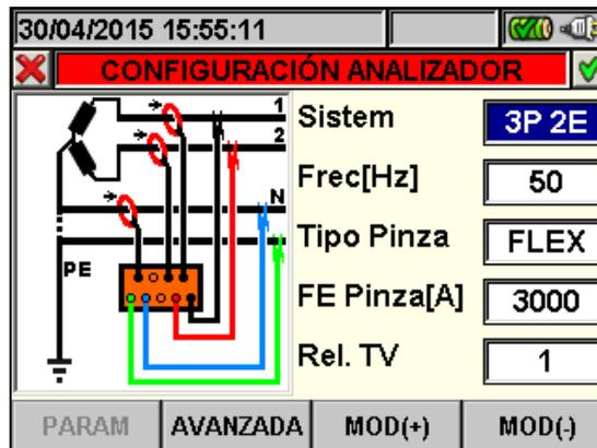
Fig. 49: Pantalla configuración analizador para sistema Bifásico 3-hilos 3P 2E
