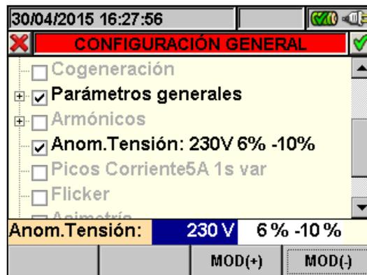
Fig. 66: Pantalla Anomalías de Tensión - programación parámetros
