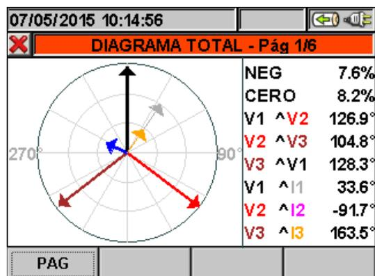
Fig. 39: Diagrama vectorial totale para sistema 4-hilos
