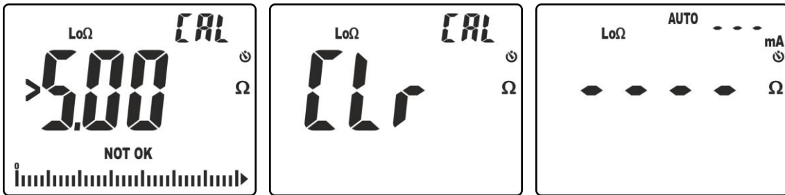
Fig. 34: Resultados puesta a cero no realizada correctamente
