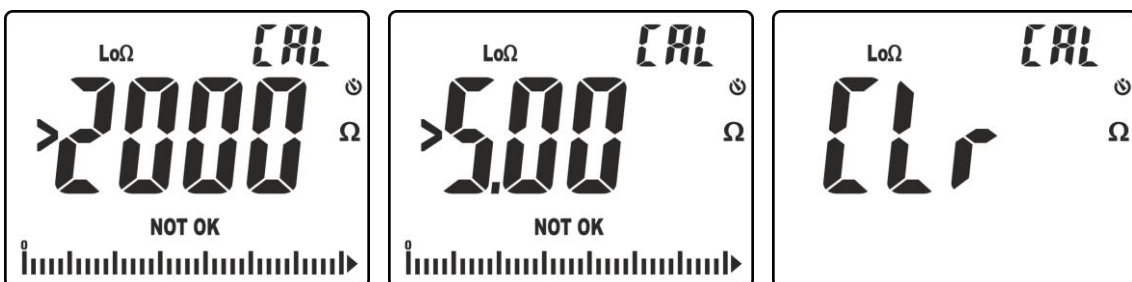
Fig. 35: Puesta a cero de una calibración
