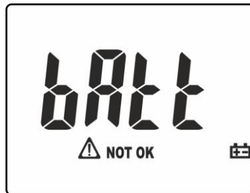
Fig. 43: Pantalla con indicación pilas descargadas
