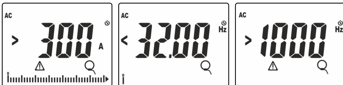
Fig. 39: Situaciones anómalas sobre la medida de corriente con transductores de pinza
