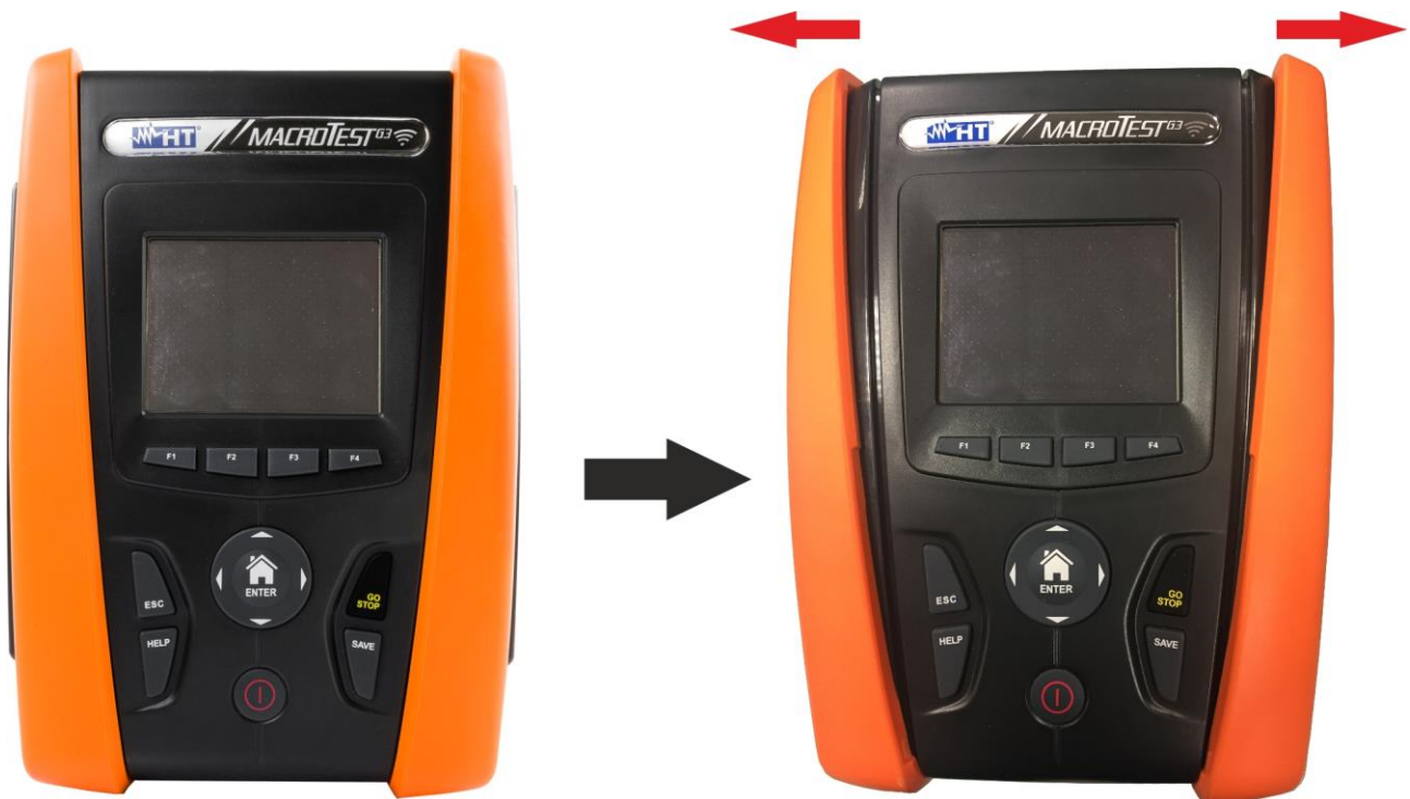
Fig. 40: Desmontaje protector de gomas laterales
