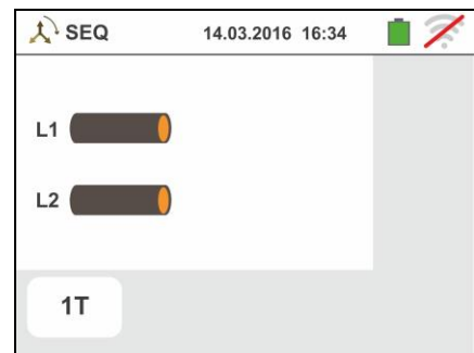
Fig. 25: Verificación del sentido cíclico de las fases 2T con terminal y punta remota
