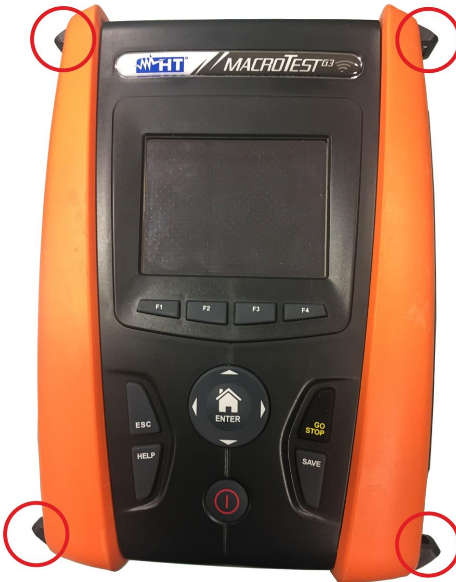
Fig. 42: Instrumento con protector de gomas y ganchos montados
