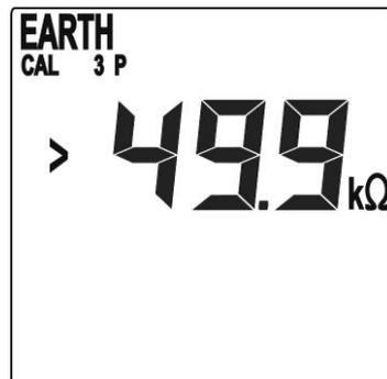
6. Cuando el circuito Voltimétrico (terminal S) presente una resistencia demasiado elevada, sobre el visualizador aparecerá el siguiente mensaje.
