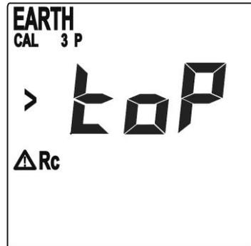
8. Cuando el circuito Voltimétrico (Terminal S) o Amperimétrico (terminal H) presenten una resistencia demasiado elevada, sobre el visualizador aparecerá el siguiente mensaje. Controle las conexiones de los cables Azul, Rojo y Verde están conectados a sus cables correspondientes.
