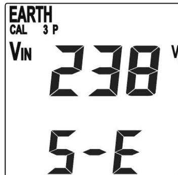
Valore della tensione rilevata in ingresso
