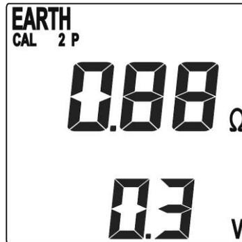
Valor medido de la Resistencia de Tierra  $R_A + R_T$
