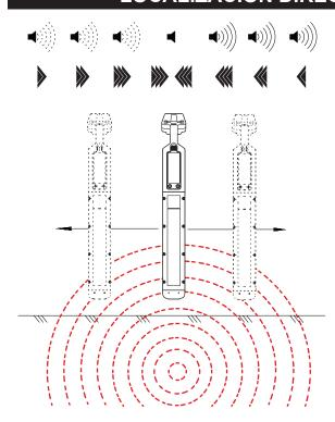
En este modo la unidad visualizará flechas direccionales hacia el conductor. El indicador audible indicará un tono sólido a un lado del conductor y un tono por pulsos en el lado opuesto del conductor. Cuando la unidad está centrada en el campo electromagnético se anulará el tono y la profundidad se visualizará brevemente en la parte de arriba del LCD. Este modo es independiente de la ganancia.
