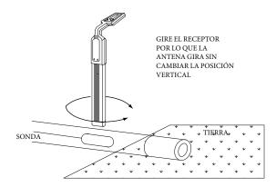
Ahora mueva el RECEPTOR de lado a lado (a través del camino de la tubería) como se muestra a continuación. Cuando se encuentra el PICO, el RECEPTOR está directamente sobre SONDA. Marque esta ubicación. A continuación, compruebe si hay señales fantasma delante y detrás del SONDA para confirmar la ubicación.
