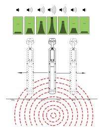
Si rota el receptor mientras se encuentre encima del cable un Null pronunciado identificará la dirección del cable. Está alineado con el lado plano del receptor.
