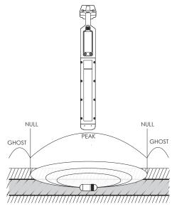
Empiece por seguir el camino sospechoso de la tubería. Deje de localizar cuando se encuentre la lectura PICO. Luego gire el RECEPTOR como se muestra en la siguiente figura. Al girar el RECEPTOR, no cambie la posición vertical. El RECEPTOR indicará un PICO cuando la antena del RECEPTOR esté alineada con la SONDA.
