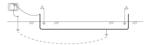
Con el transmisor apagado conecte el cable rojo al conductor con la falla y el cable negro a la pica de tierra independiente detrás y en linea con la ruta del cable.
